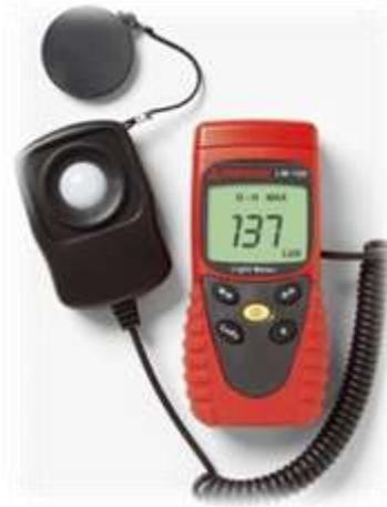
**Figura 7.** Luxómetro modelo LM-100
