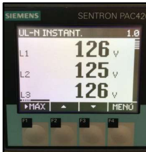
FIGURA 67. VOLTAJES DE FASE EN EL SENTRON PAC.
