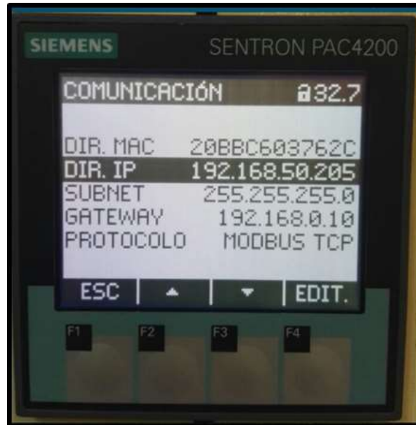
FIGURA 58. AJUSTE DE DIRECCIÓN IP DEL SENTRON PAC.
