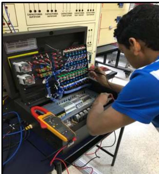
FIGURA 41: PRUEBA DE CONTINUIDAD EN EL MÓDULO.
