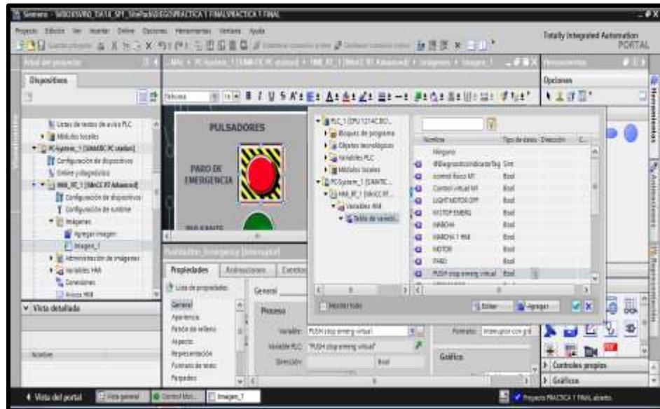
FIGURA 87. AGREGAR VARIABLE A LOS BOTONES DE LA PANTALLA HMI.
