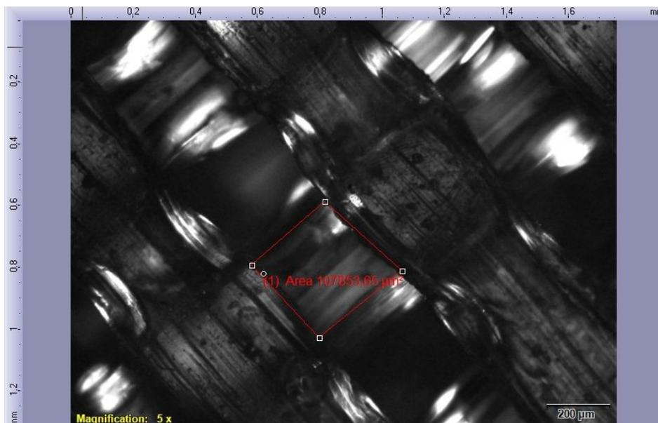
**Figura 1.37** – Longitud del poro con geometría cuadrada, de la oreja impresa con PLA/5MLO a una densidad de llenado del 40%. . Fuente: Autor.
