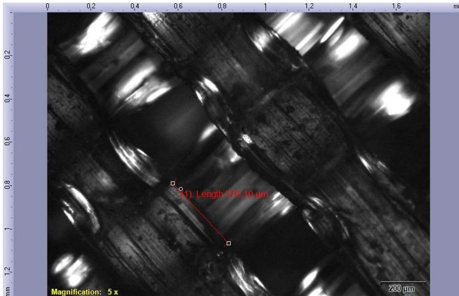
**Figura 1.36** – Longitud del poro con geometría cuadrada, de la oreja impresa con PLA/5MLO a una densidad de llenado del 40%. . Fuente: Autor.
