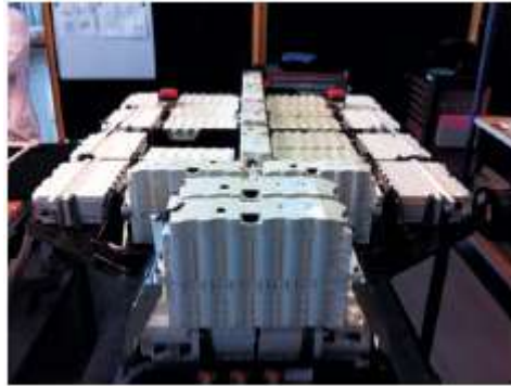
Figura. 8. Batería níquel hidruro metálico para la tracción de un vehículo eléctrico grande.
