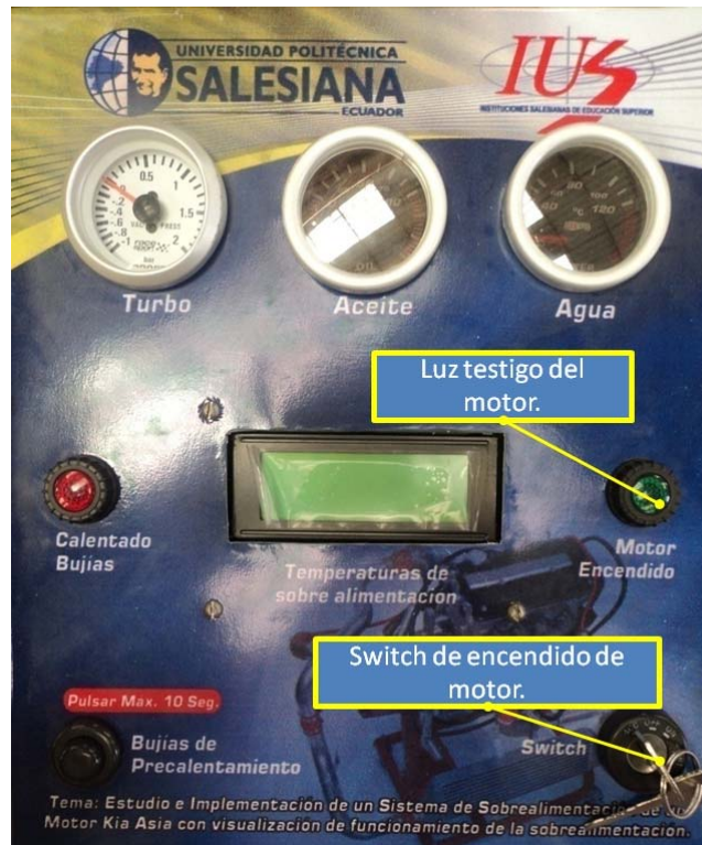
Fig. 6. 5 Switch y luz testigo del motor en el tablero de control.
