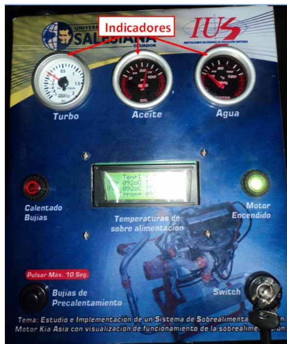
Fig. 4. 38 Tablero de comando y control.
