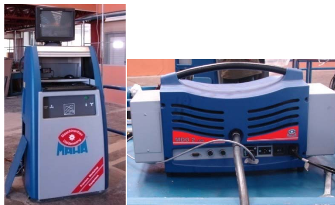
Fig. 5. 5 Banco para medición de opacidad y Opacímetro MAHA MDO 2
