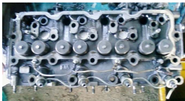
Fig. 4. 11 válvulas montadas en el cabezote de motor Kia Asia Hi-Topic.
