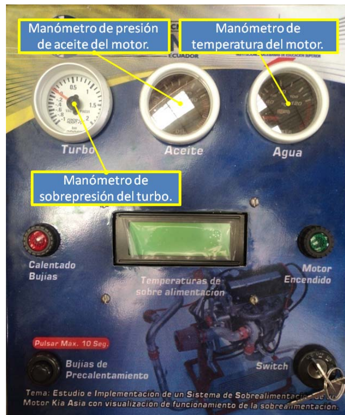
Fig. 6. 7 Manómetros de verificación del funcionamiento de motor Kia Asia Hi-Topic.
