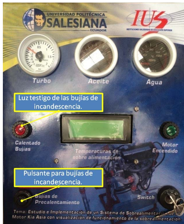
Fig. 6.4 Pulsante y luz testigo de las bujías de precalentamiento en el tablero de control.
