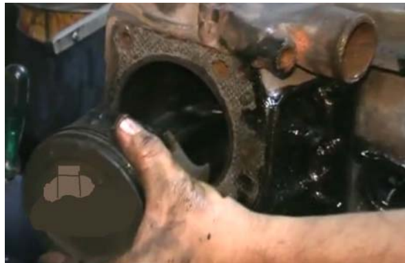
Fig. 4. 6 Desmontaje del pistón y biela del motor Kia Asia Hi-Topic.
