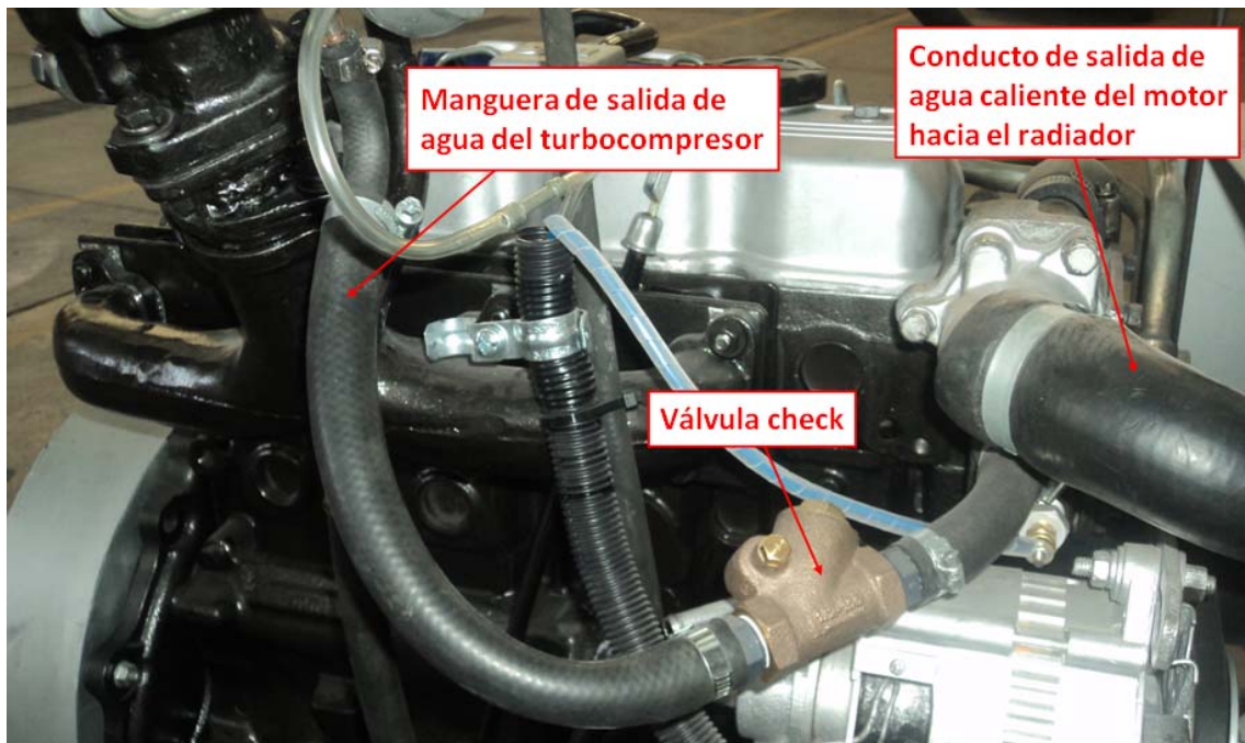
Fig. 4. 23 Disposición de la válvula check.
