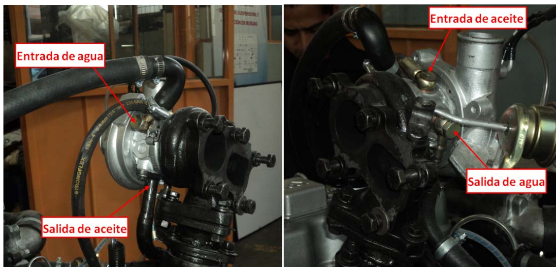
Fig. 4. 22 Líneas de agua y aceite conectadas al turbocompresor.
