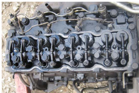
Fig. 4. 2 Vista superior del cabezote del motor diesel Kia Asia Hi-Topic.
