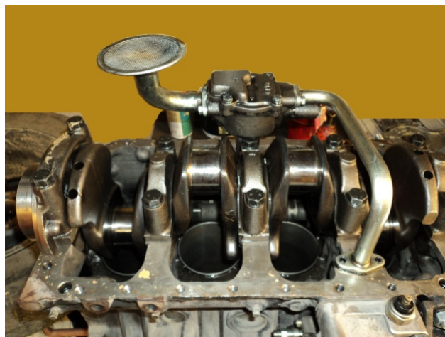
Fig. 4. 8 Montaje del cigüeñal del motor Kia Asia Hi-Topic.
