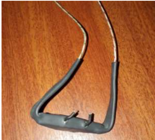
Figura 25. Sensor de flujo de aire empleado en el proyecto.
