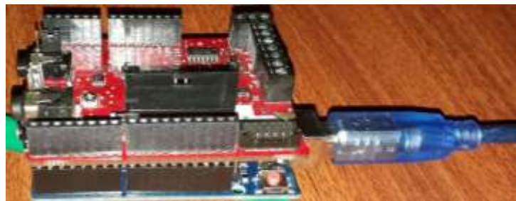
Figura 50. Conexión entre la placa v2.0 y el Arduino Uno realizada por el autor
