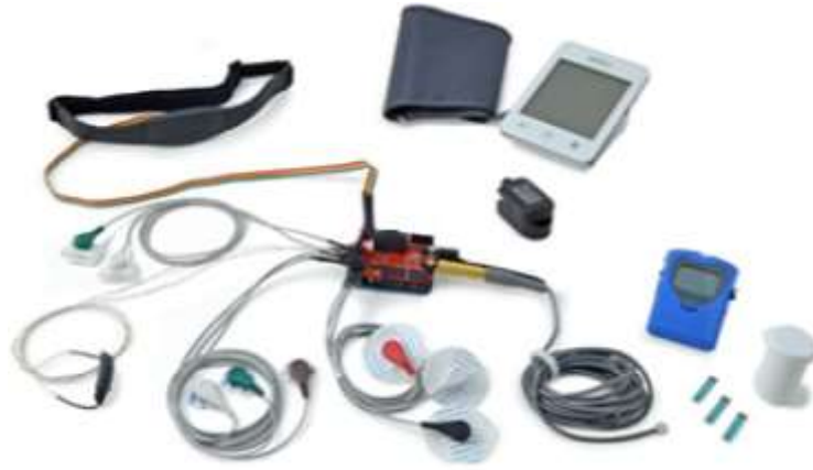
Figura 47. Conexión de todos los sensores a la placa v2.0 (Cookings Hacks, 2017)
