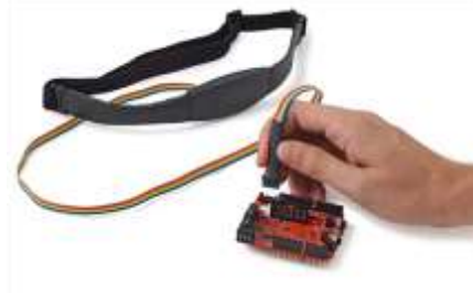
Figura 43. Conexión del sensor de posición a la placa v2.0. (Cookings Hacks, 2017)
