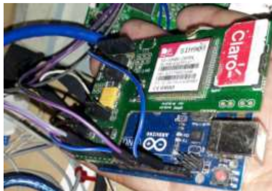
Figura 58. Módulo GPRS conectado al Arduino uno.
