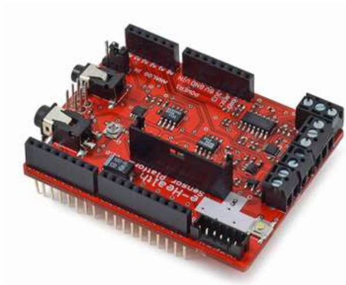
Figura 9. Placa v2.0 para sensores e-Health para Arduino y Raspberry Pi. (Cookings Hacks, 2017)
