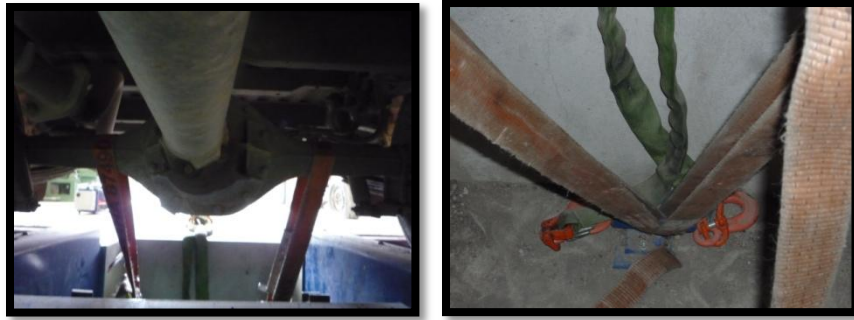
Fig. 3.12 Correas de seguridad colocadas en el eje trasero del vehículo y fijadas al suelo
