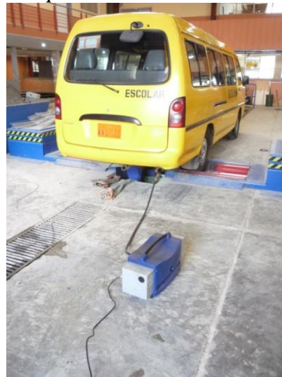
Fig. 3.32 Opacímetro conectado al tubo de escape
