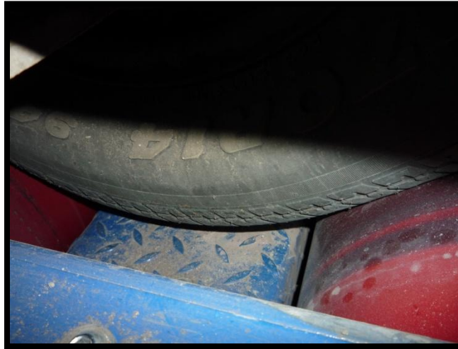
Fig. 3.11 Neumáticos no rozan con soportes de rodillos.
