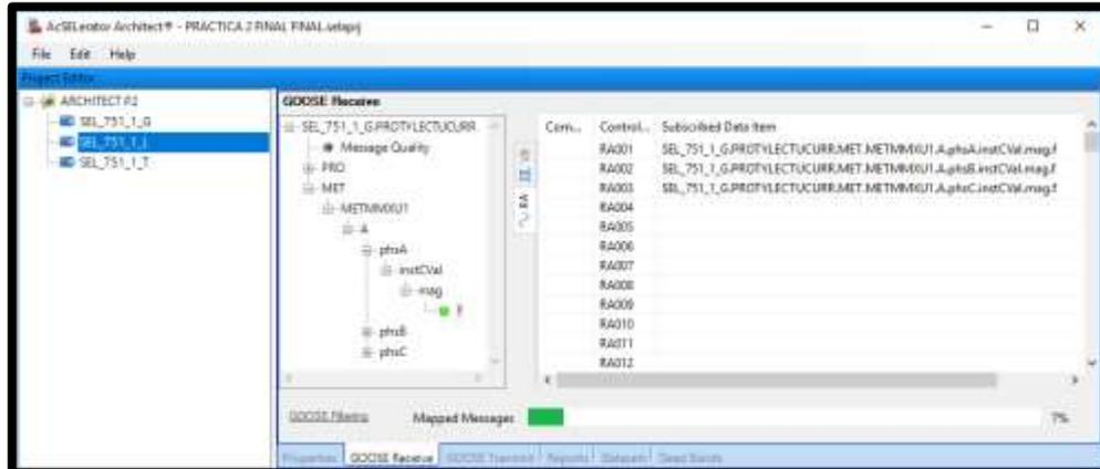
FIGURA 108: AJUSTE DE RECEPTOR GOOSE – VALORES ANALÓGICOS
