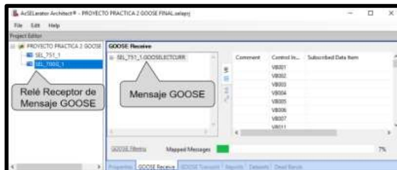
FIGURA 73: SELECCIÓN DE RELÉ RECEPTOR DE GOOSE
