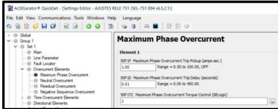
FIGURA 141: AJUSTE DE FUNCIÓN DE PROTECCIÓN 50
