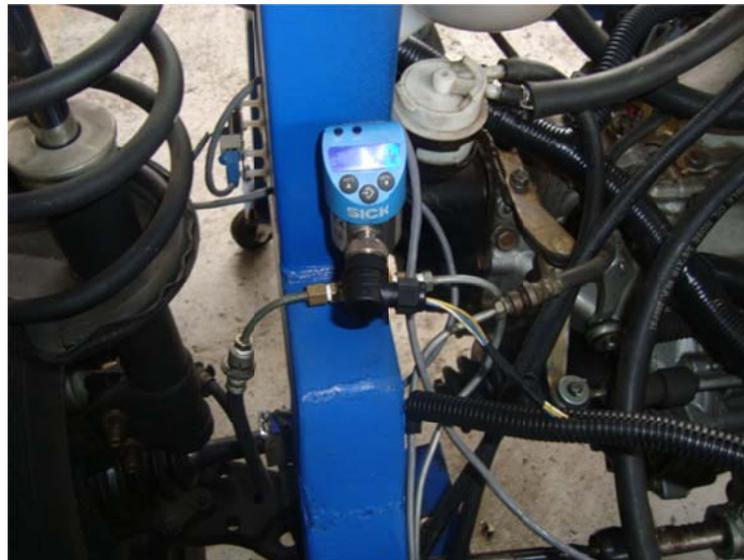
**Fotografía 4.9.** Montaje del sensor de presión del freno
