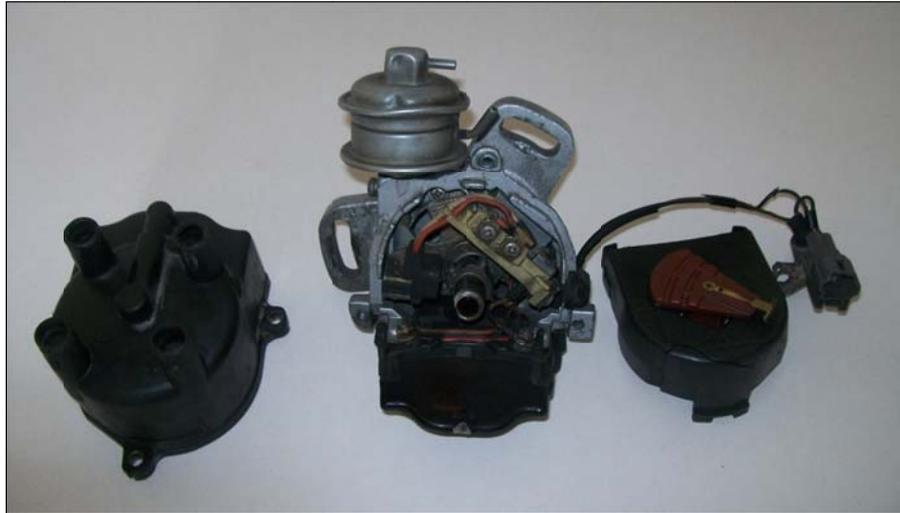
**Fotografía 4.1.** Sensor de Posición del Distribuidor
