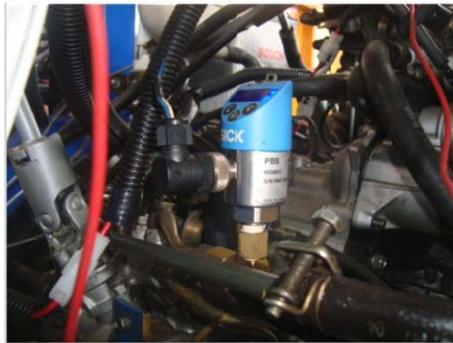
**Fotografía 4.12.** Sensor de presión de la dirección
