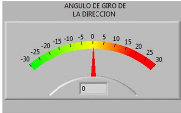
**Figura 4.52.** Visualización indicador ángulo de giro de la dirección
