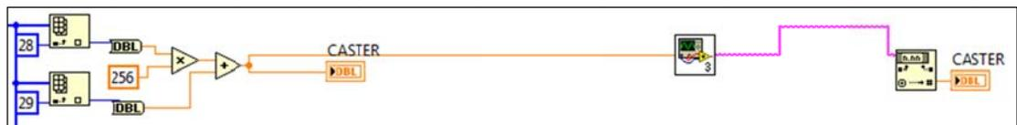
**Figura 4.59.** Diagrama de bloques de indicador de ángulo Caster
