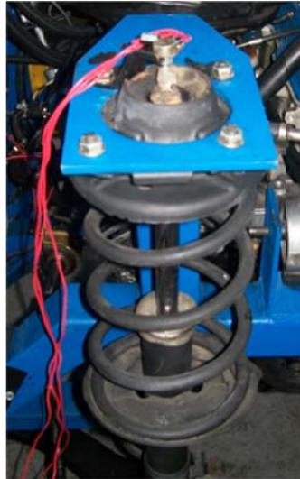
**Fotografía 4.14.** Sensor de ángulo de convergencia divergencia
