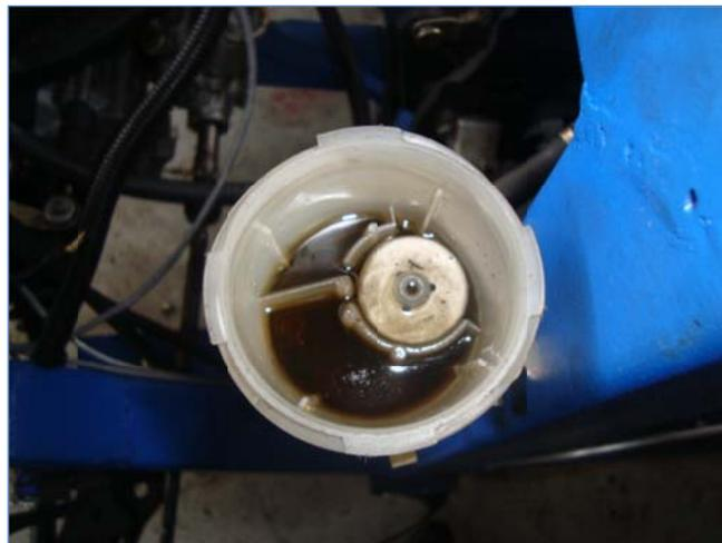
**Fotografía 4.10.** Sensor de nivel del líquido de freno
