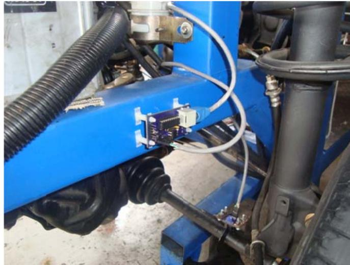
**Fotografía 4.7.** Sensor de RPM de los ejes conexión con PIC
