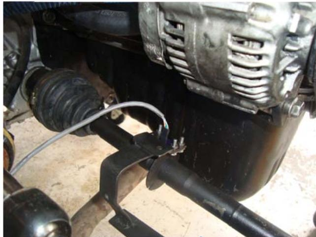
**Fotografía 4.6.** Sensor de RPM de los ejes
