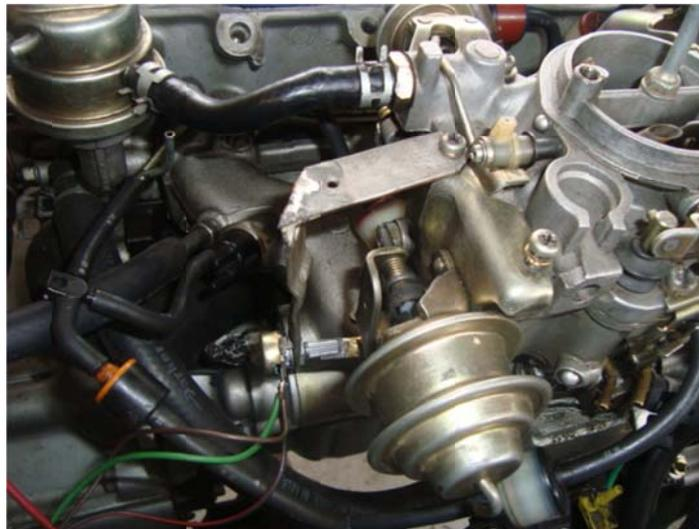
**Fotografía 4.5.** Sensor de apertura de mariposa de aceleración
