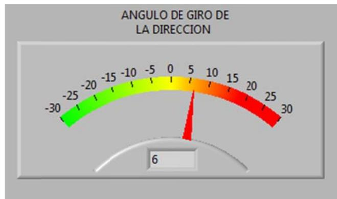
**Figura 4.53.** Visualización indicador ángulo de giro de la dirección moviendo la dirección a la derecha
