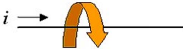
Figura 2.13 Generación campo magnético
