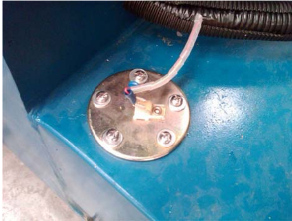
Figura 2.10 Ubicación del sensor de combustible
