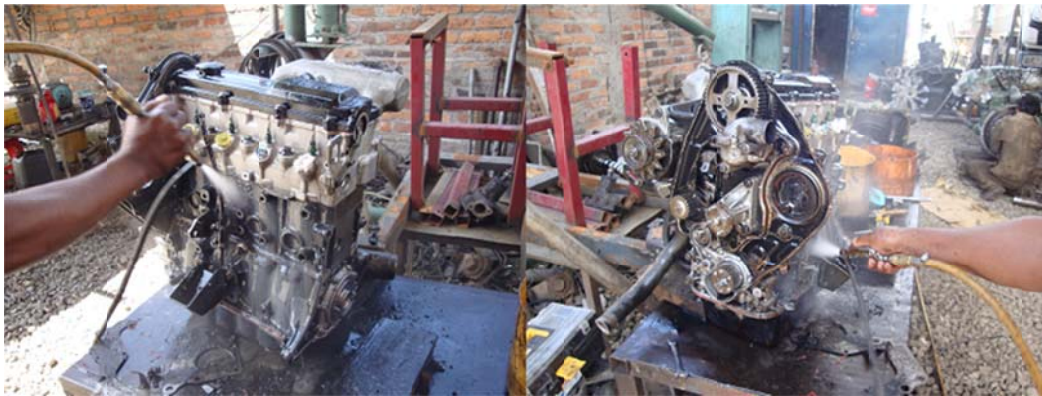
Figura 1.3 Lavado y limpieza del cuerpo del motor
