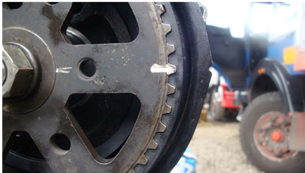
Figura 1.10 Ajuste bomba de inyección-carcasa
