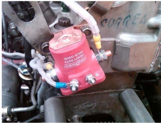
Figura 2.25 Relé de alta capacidad para pre calentamiento
