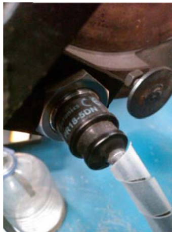
Figura 2.18 Ubicación del sensor de revoluciones
