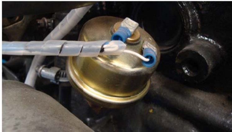
Figura 2.7 Ubicación del sensor de presión de aceite
