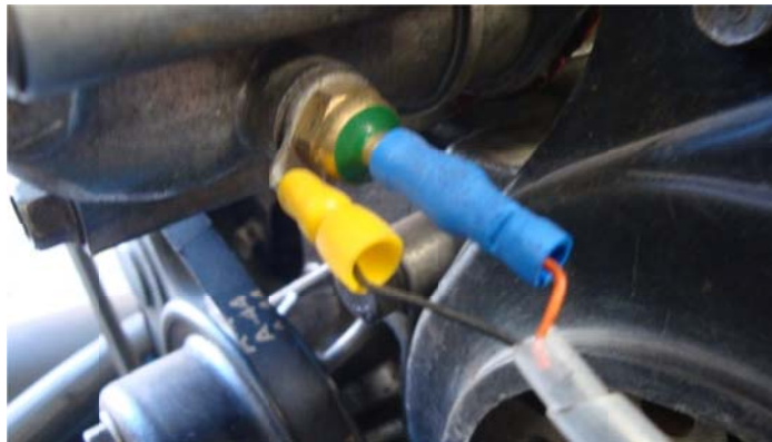
Figura 2.4 Ubicación del sensor de temperatura
