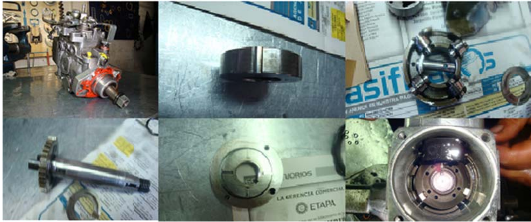
Figura 1.6 Despiece de la bomba de inyección
