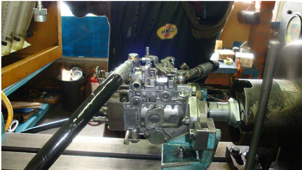
Figura 1.8 Bomba de inyección en el banco
