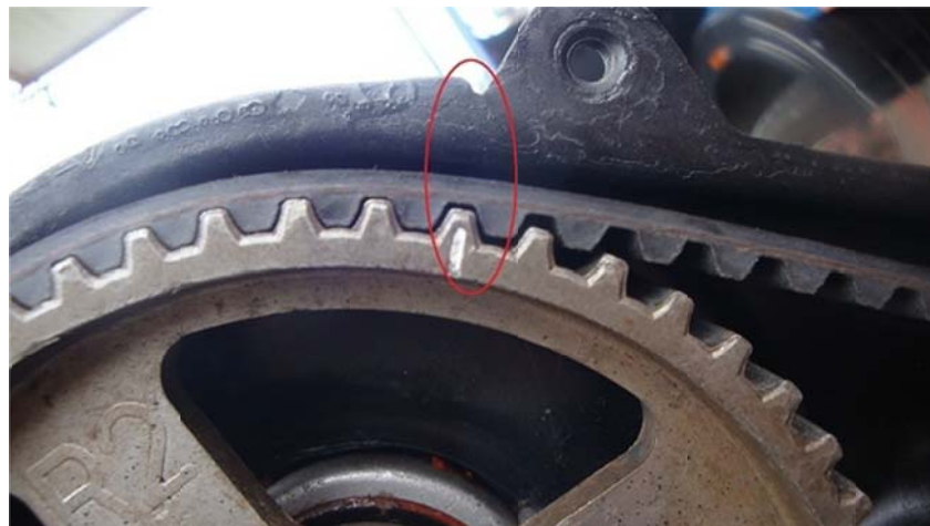
Figura 1.12 Ajuste árbol de levas-carcasa
