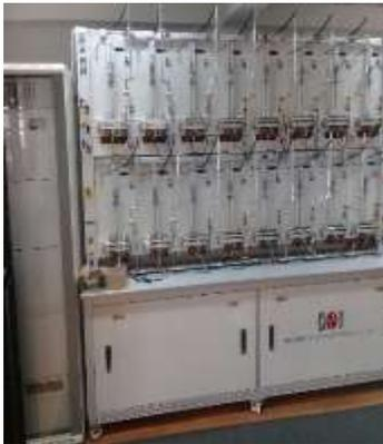
**Descripción:** CL30005 es una Mesa de prueba multifuncional de tecnología avanzada para probar tipos de medidores electrónicos trifásicos, medidor de energía de múltiples funciones trifásicos, medidores de energía PLC trifásicos y medidores multirifa trifásicos (prepagos).
