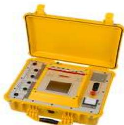
**Descripción:** Este dispositivo está diseñado para la medición de una resistencia de carga inductiva con un alto grado de precisión, aplicando un nivel de corriente prefijado, seleccionado por el usuario, de 0,025A a 50A.
