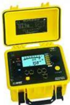
**Descripción:** Pose la Capacidad para medir la resistencia de aislamiento hasta 30TΩ. Resistentes a la intemperie garantizando pruebas en campo, son exactos, confiables y construidos para un trabajo propio de mantenimiento eléctrico.
