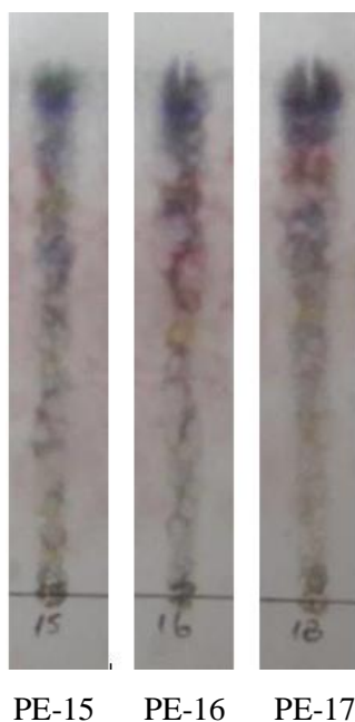
Figura 5.- Revelado cromatográfico con vainillina al 1% en etanol, ácido sulfúrico al 50 % en etanol y calor.
