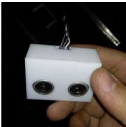
Figura 166 Conexión del sensor de distancia del sistema de Alimentación
