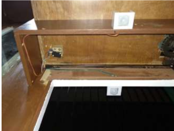
Figura 125 FC Cierra, sensor PIR interno y externo del sistema de acceso
