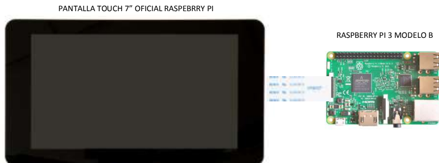
Figura 86 Diagrama de conexión de pantalla táctil a raspberry pi
