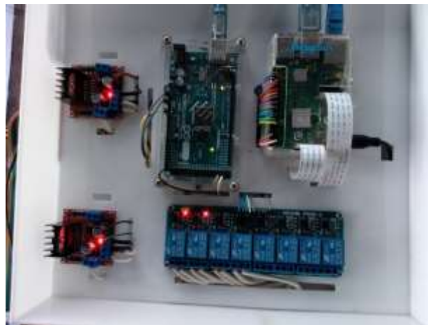
Figura 192 Se activa ambos relés de L1 y L2
