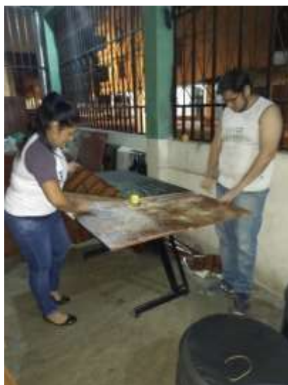
Figura 54 Pegado del linóleo a base de la casa
