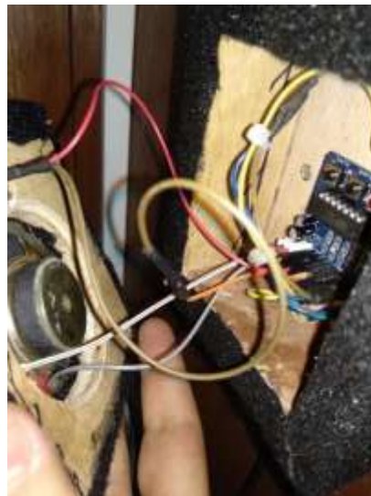
Figura 165 Conexión del circuito reproductor de voz y led en caja de resonancia
