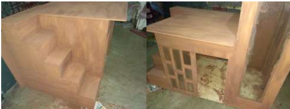
Figura 51 Casa lijada, tratada y con base de color
