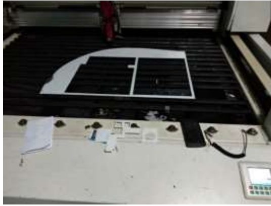
Figura 140 Corte laser de las piezas del centro de control y contenedor de sensores
