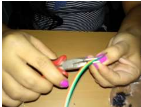
Figura 158 Ponchado de cables tipo puente para sensores
