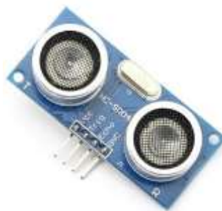
Figura 24 Sensor de distancia de ultrasonido HC-SR04
