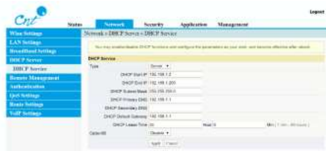
Figura 91 Configuración DHCP de router Huawei propiedad de CNT
