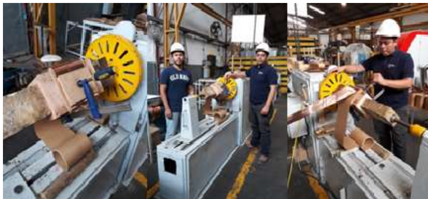
Figura 24: Proceso de confección de arrollamiento de baja tensión Fuente: Los autores
