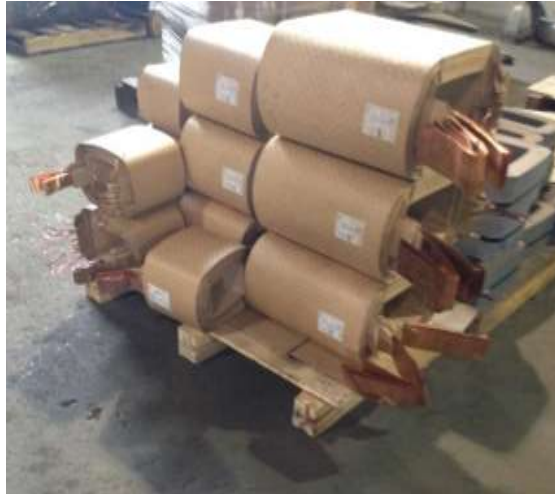
Figura 6: Bobinas aisladas con papel presspan
