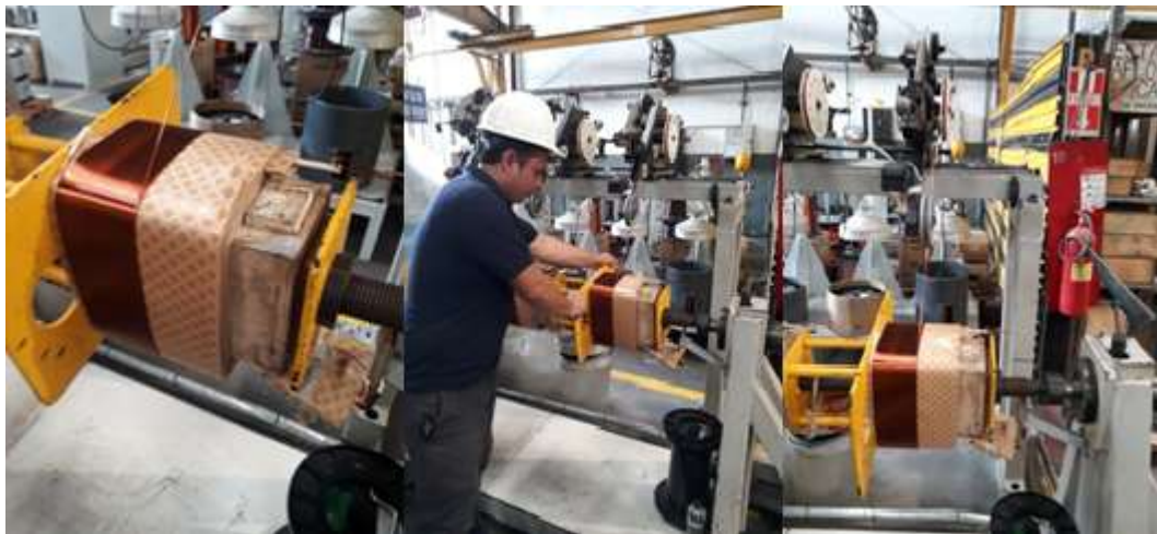
Figura 26: Proceso de confección de arrollamiento de alta tensión
