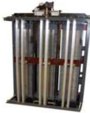
Figura 45: Transformador utilizado para realizar la prueba sin carga Fuente: Hipotronics [26]
