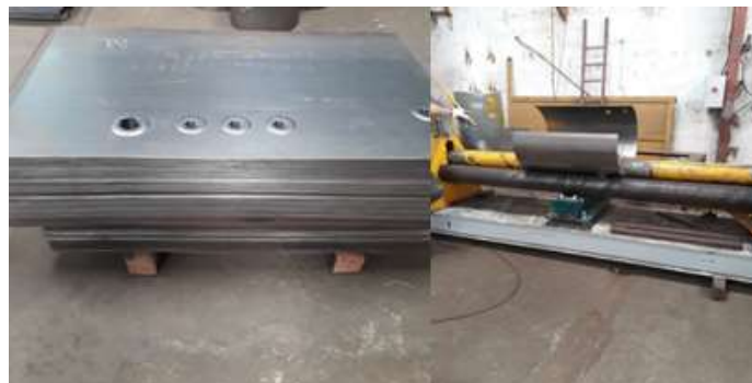
Figura 29: Proceso de producción y rolado de tanque de lámina de acero al carbón Fuente: : Los autores
