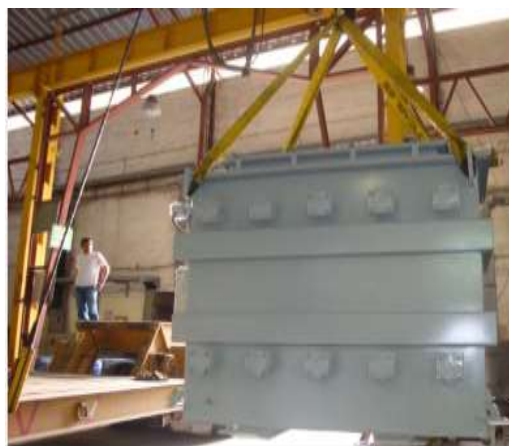
Figura 10: Tanque de transformador
