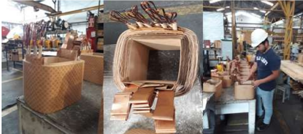
Figura 27: Ensamble de devanados de alta y baja tensión Fuente: Los autores
