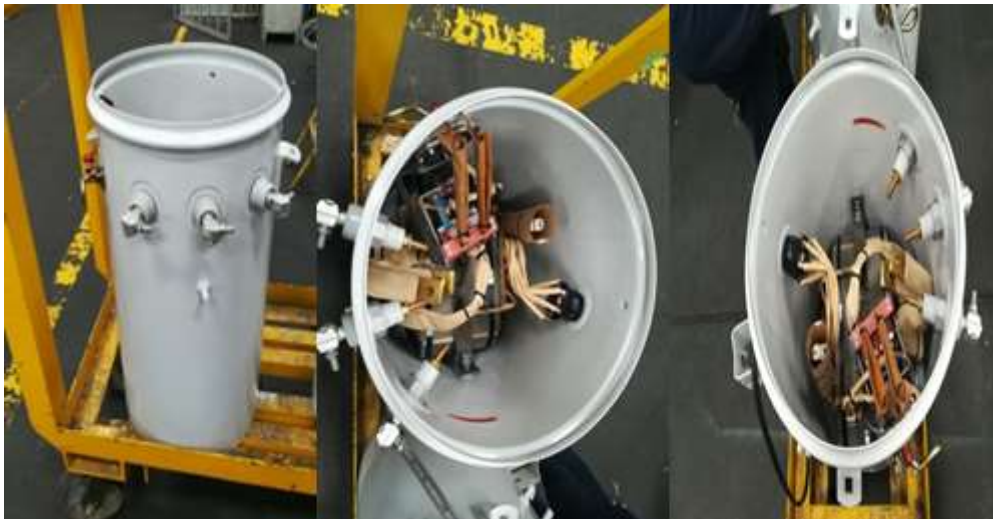
Figura 37: Montaje de la parte activa al tanque Fuente: Los autores
