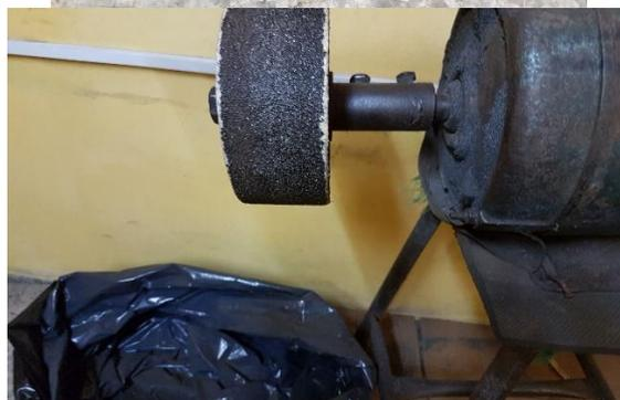
**Figura A. 5** Esmeril para la formación del arco longitudinal
