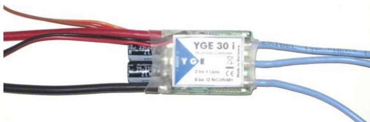
Figura 2. 14 Controlador electrónico de velocidad
