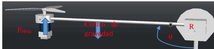
Figura 3. 2 Fuerzas que actúan sobre la estructura
