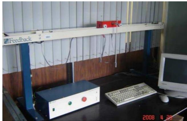
Figura 1. 1 Péndulo invertido sobre base móvil (Fuente: Sánchez, 2007)
