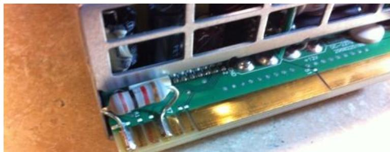
**Figura 2. 9** Hewlett Packard DPS-1200FB con resistencia 1000 ohms
