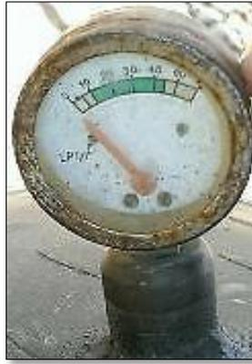
**Figura 10.** Manómetro de 60 psi
