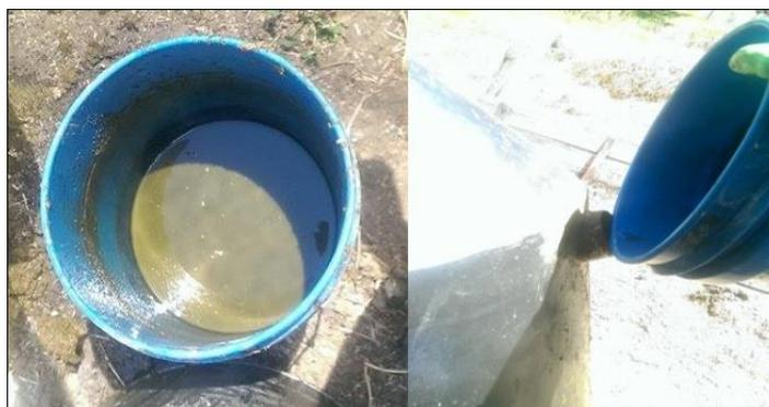
*Figura 18. Carga del biodigestor con estiércol bovino*
