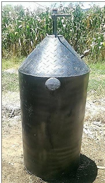
***Figura 17. Biodigestor cilíndrico de hierro***
