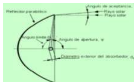
Figura 19. Ángulo de aceptación y apertura Fuente: (Zarza, 2013)
