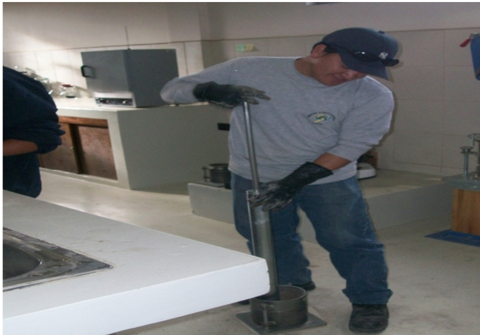
Fotografía 2 Moldes y martillo para compactación
