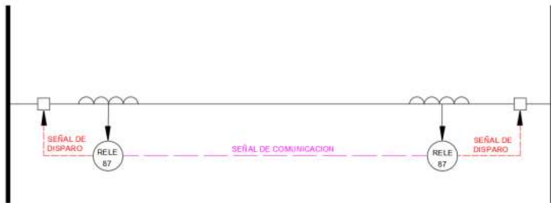
Figura 56. Protección diferencial de línea. (Elaboración propia), (ABB, Protección diferencial de Línea RED 670, 2011)
