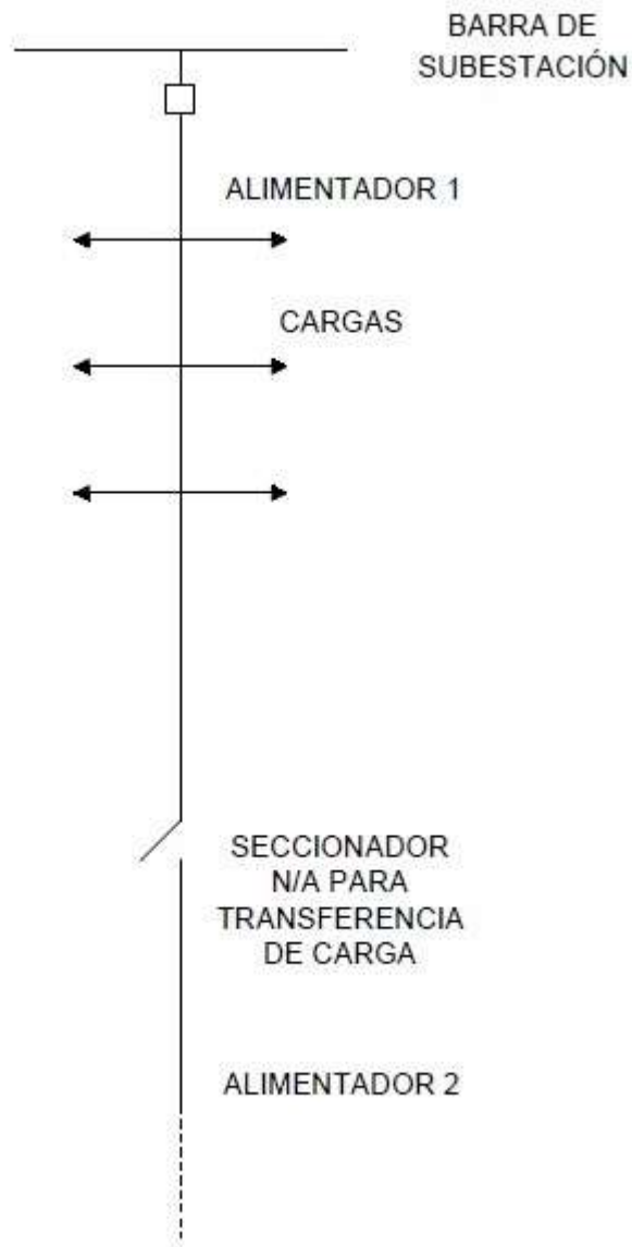
Figura 10. Configuración Radial. (Abdelhay & O.P, 2012), ( Sistemas de Distribucion ), (Elaboración propia).
