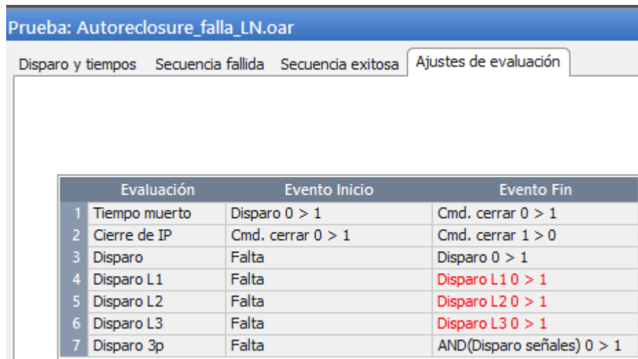
Figura 145. Ajustes de evaluación – Función 79 – Autoreclosure. (Omicron, Software Test Universe 3.10, 2016)
