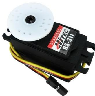
Gráfico del motor a usarse para dar el ángulo de inclinación en la planta, Autor: (Hitecrd, 2017)
