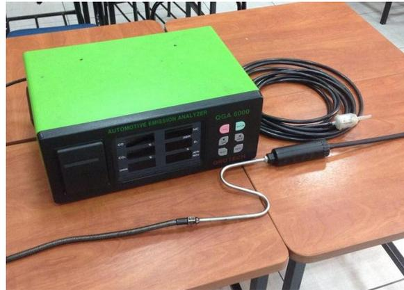
Figura 6.27. Analizador de Gases
