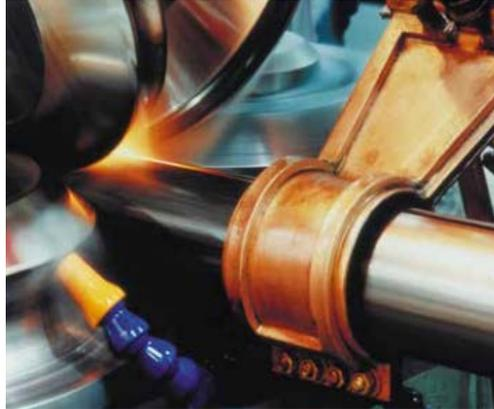
**Figura 2.3** Soldadura por inducción
