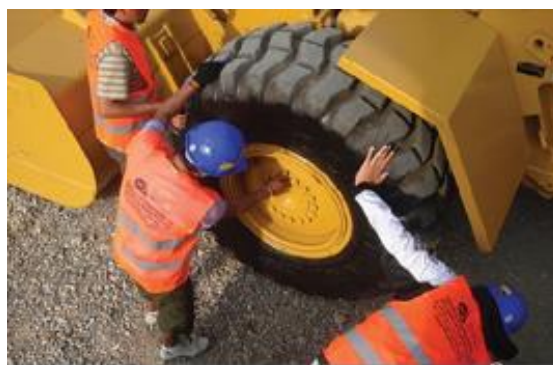
Figura 9: Inspección visual. Fuente: (Caterpillar, 2017).
