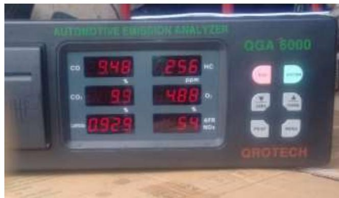
*Figura 16. Valores de gases en ralentí. Fuente: Los Autores*
