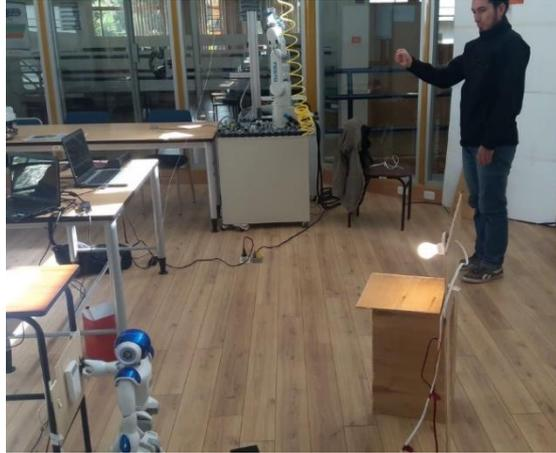
Encendido de foco mediante réplica de movimiento
