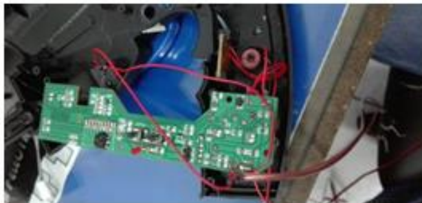
Resultado de la soldadura de cables
