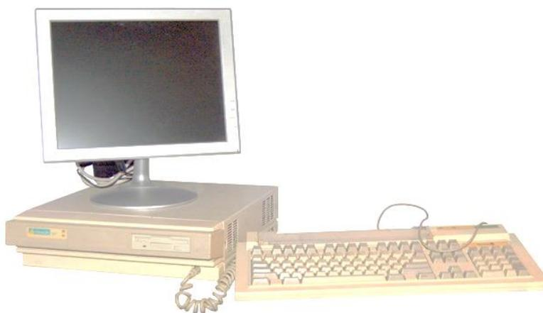
Computador diseñado con un procesador ARM2, Fuente: (Caprile, 2012)
