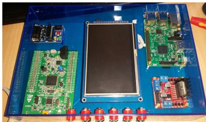
Caja de control con las tarjetas utilizadas en el sistema, Elaborado por: Andrade & Chulca
