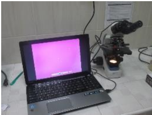
Visualización y conteo de Trazas nucleares en el detector LR-115 tipo II con el microscopio óptico BOECO Germany, cámara Digital Celestron y una laptop Toshiba Satellite
