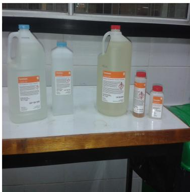
**Figura 1.31** – Líquido Fijador (A+B) y Líquido Revelador (A+B+C). **Fuente:** Autor.
