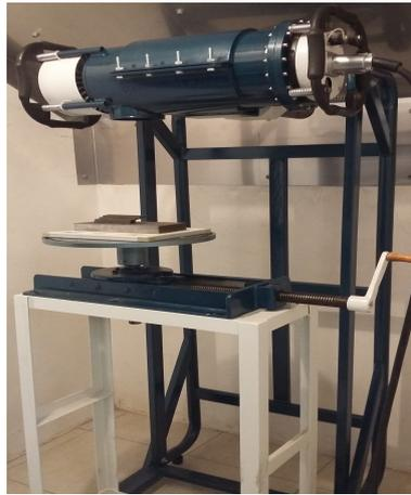
**Figura 1.28** – Tubo generador de rayos X. **Fuente:** Autor.
