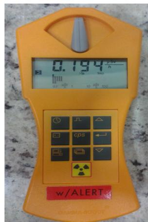
**Figura 1.34** – Medidor de radioactividad digital Geiger-Müller de marca GAMMA-SCOUT®. **Fuente:** Autor.
