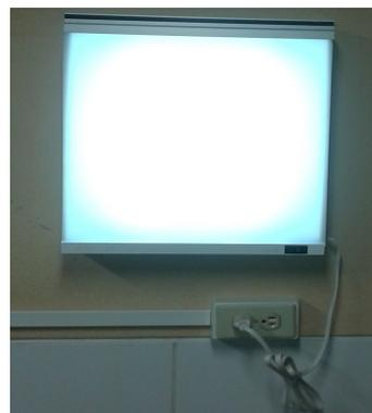
**Figura 1.36** – Negatoscopio. **Fuente:** Autor.
