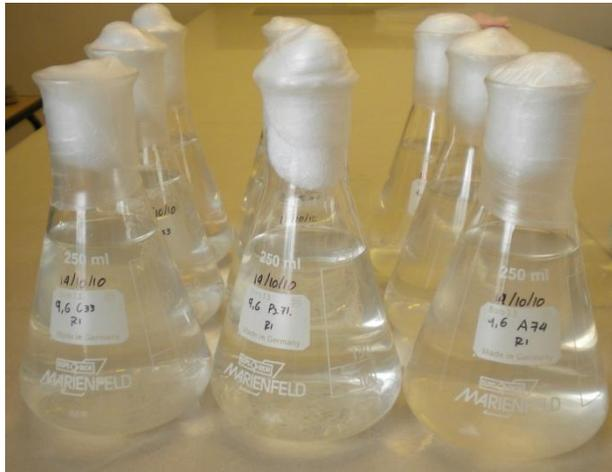
**Ilustración 13:** Soluciones testigos preparados en matraces de 250 ml a temperatura ambiente.
