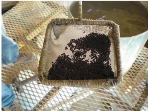
**Ilustración 5.-** Carbón Activado empleado en el proceso aurífero para captar las partículas de oro
