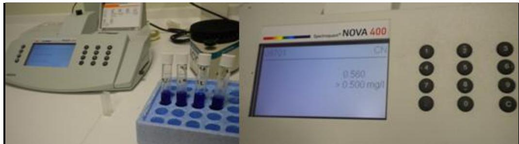
**Ilustración 18:** Determinación de las concentraciones de cianuro por espectrofotometría
