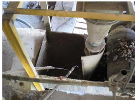
**Ilustración 3.-** Tanques para la adición de cal y solución de cianuro de sodio
