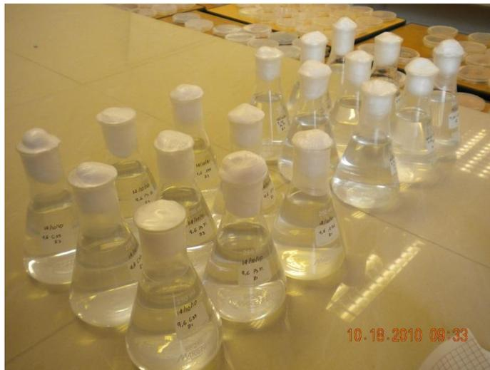
**Ilustración 14:** Soluciones bioensayos preparados en matraces de 250 ml a temperatura ambiente.
