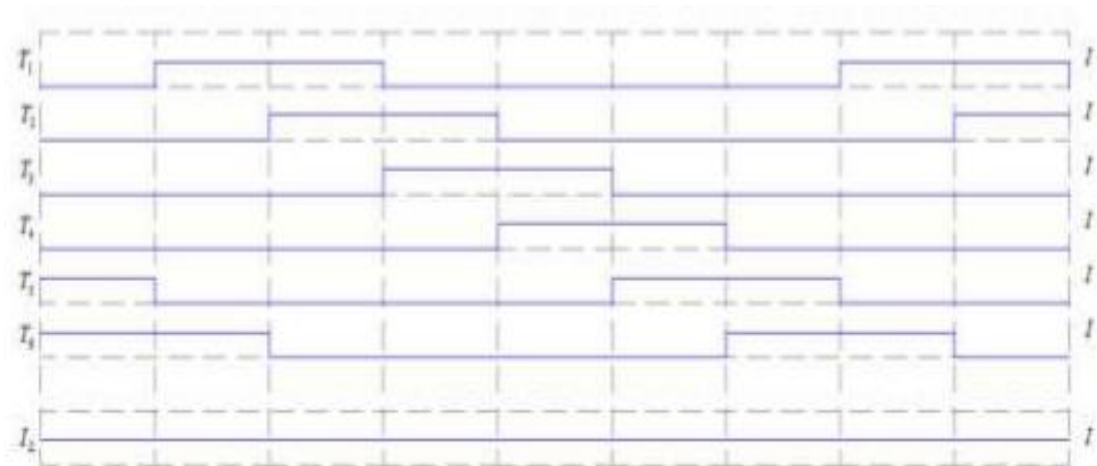
Pulsos de disparo a los tiristores, Fuente: Pavón, 2012.
