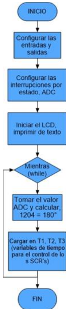
Figura 2.19. Funcionamiento de la subrutina principal y configuración
