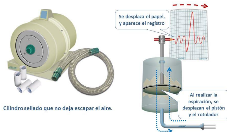
Figura 8. Espirómetro de Pistón [11]
