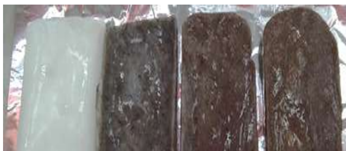
Figura 16. PCL dosificado con la Lignina. Fuente La Autora
