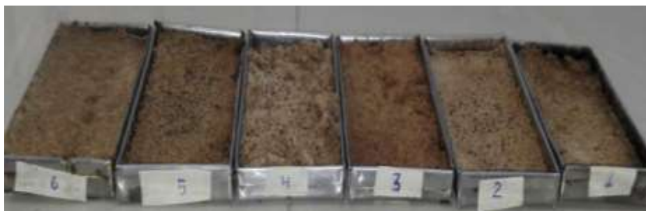
Figura 15. Biopolímeros en sus moldes fuera de la estufa Fuente La Autora.
