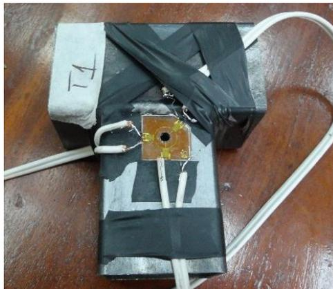
**Figura 32.** Instalación correcta de galga extensiométrica sobre probeta.
