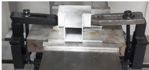
**Figura 39.** Sujeción de probeta sobre la mesa de CNC.
