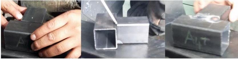
**Figura 25.** Elaboración de puntos de fusión en juntas por medio de soldadora eléctrica SMAW
