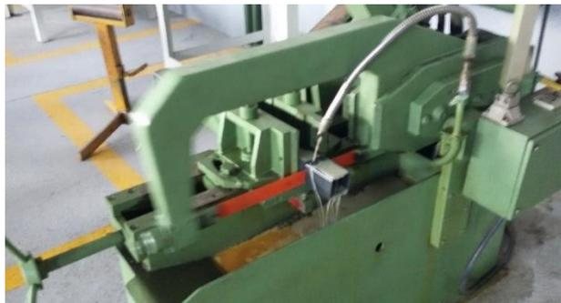
**Figura 24.** Corte de material por medio de sierra de corte alternativa
