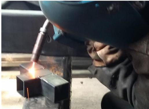
**Figura 26.** Elaboración de cordones en probetas por medio de Soldadura GMAW
