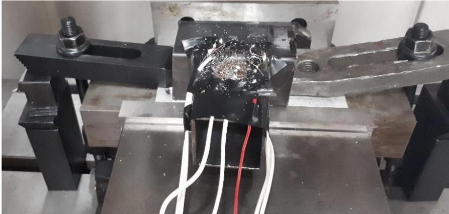
*Figura 33. Montaje y sujeción de probeta sobre mesa CNC.*
