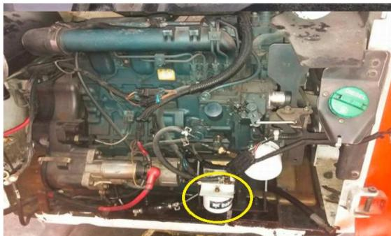
Figura 44. Filtro de combustible localizado en el motor. Fuente: Autores.
