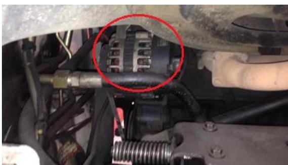
*Figura 10. Alternador del Cargador Bobcat S175. Fuente: Autores.*
