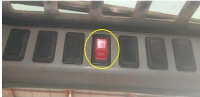
Figura 10. Pulsante del freno de estacionamiento. Fuente: Autores.
