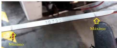
Figura 25. Niveles máximo y mínimo de aceite en la varilla del motor. Fuente: Autores.
