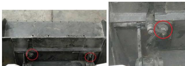
Figura 21. Punto de lubricación en el cilindro del Bob-tach. Fuente: Autores.
