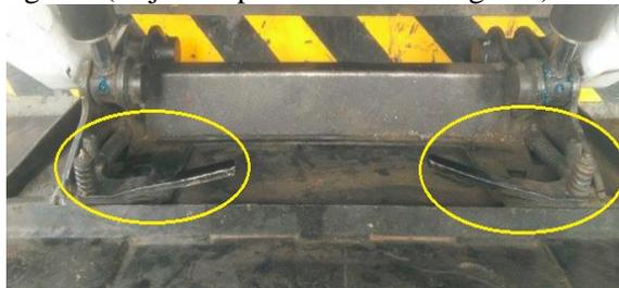
Figura 15. Colocar los seguros del Bobtach. Fuente: Autores.
