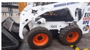
Figura 15. Bajar el cargador hasta que las ruedas se apoyen en el piso. Fuente: Autores.
