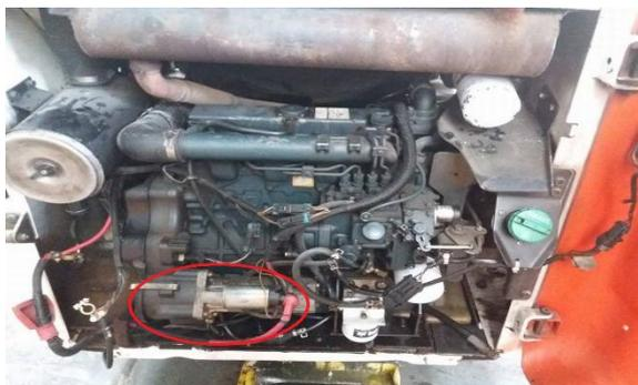
*Figura 5. Ubicación del motor de arranque en el cargador Bobcat S175. Fuente: Autores.*
