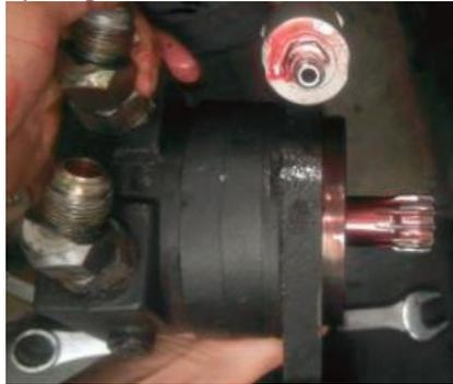
*Figura 1. Motor hidráulico tipo Geroller de un cargador Bobcat S175. Fuente: Autores.*
