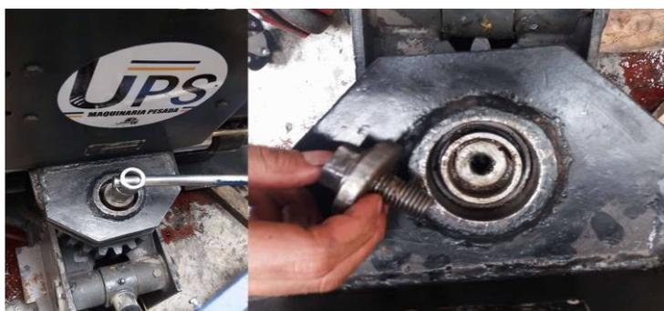
Figura 7. Perno del eje del piñón retirado. Fuente: Autores.
