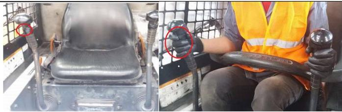
Figura 20. Activación en el pulsante del mando derecho de desplazamiento. Fuente: Autores.
