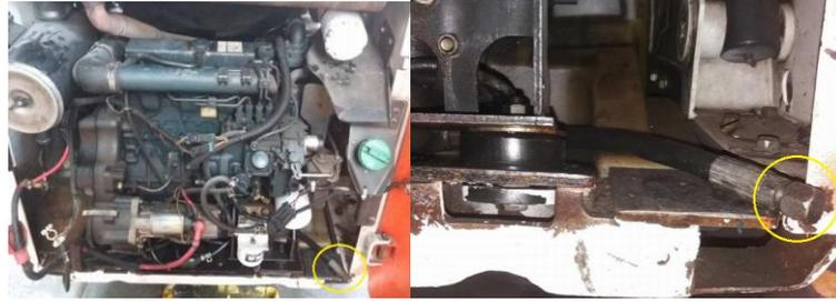
Figura 27. Tapón de drenaje del aceite de motor. Fuente: Autores.
