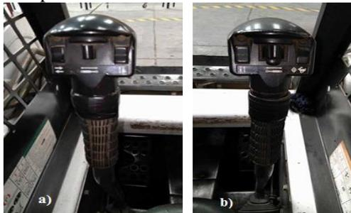
Figura 12. Mandos de desplazamiento izquierdo y derecho del cargador Bobcat S175. Fuente: Autores.
