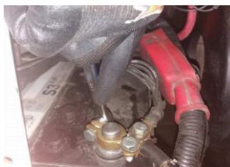
Figura 21. Desconexión de los bornes de la batería. Fuente: Autores.
