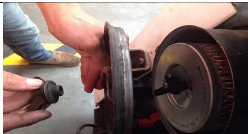
Figura 12. Extracción de la tapa antipolvo del filtro de aire. Fuente: Autores.
