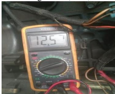
Figura13. Medición de voltaje de la batería. Fuente: Autores.
