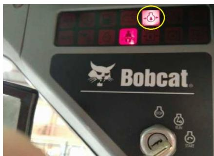
Figura 7. Indicador de baja presión de aceite de motor. Fuente: Autores.
