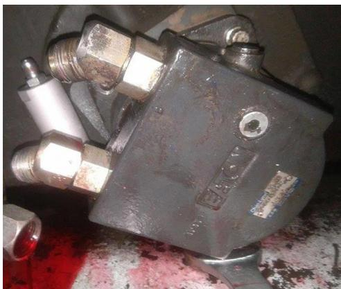
*Figura 12. Montaje del motor hidráulico en su lugar de funcionamiento. Fuente: Autores.*
