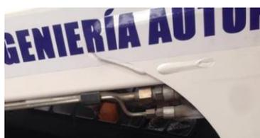
*Figura 14. Acoples de las cañerías hidráulicas. Fuente: Autores.*
