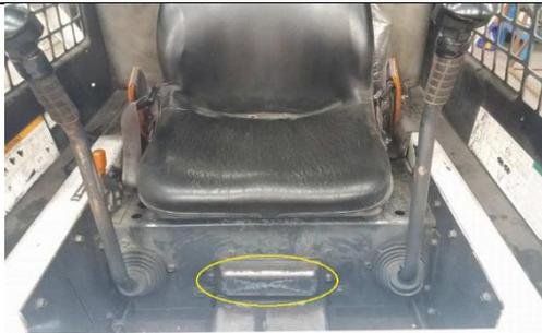
Figura 28. Ubicación de la caja de fusibles. Fuente: Autores.
