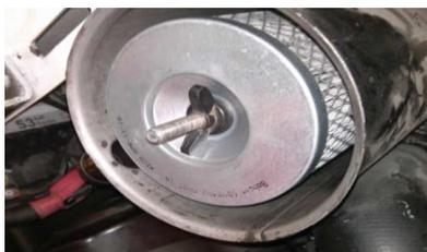
Figura 16. Ajuste de la mariposa del filtro exterior. Fuente: Autores.
