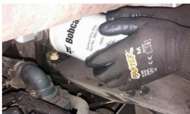
Figura 35. Apriete del filtro de aceite hidrostático. Fuente: Autores.
