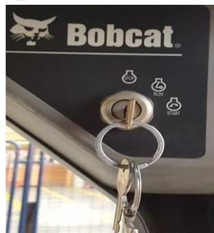
Figura 7. Switch de encendido. Fuente: Autores.
