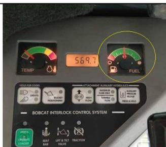
Figura 39. Medidor del nivel de combustible. Fuente: Autores.
