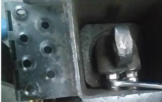
Figura 25. Conexión de las cañerías hidráulicas. Fuente: Autores.
