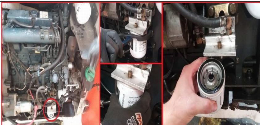
Figura 46. Extracción del filtro de combustible. Fuente: Autores.
