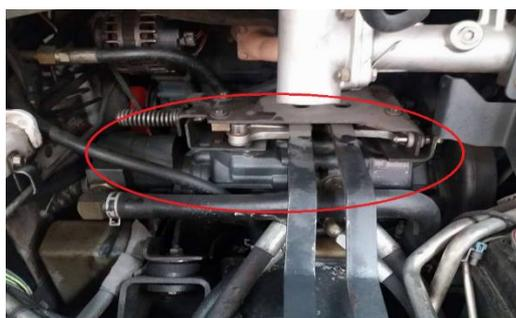
Figura 18. Bomba hidráulica de un cargador Bobcat S175. Fuente: Autores.
