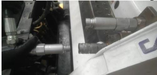
Figura 11. Conexión del puerto hidráulico IN. Fuente: Autores.
