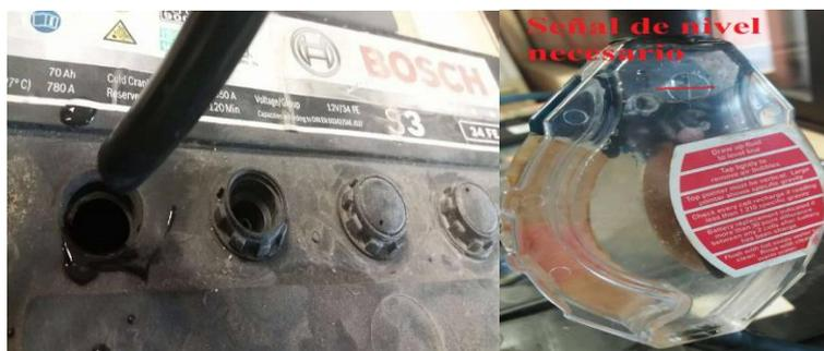
Figura 27. Extracción de electrolito con el densímetro. Fuente: Autores.
