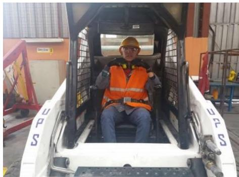
Figura 14. Cinturón de Seguridad. Fuente: Autores.
