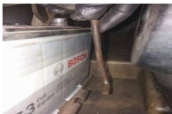
Figura 22. Varilla de sujeción de la batería desenganchada. Fuente: Autores.
