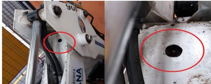
Figura 29. Punto de lubricación en la articulación de la pluma y el brazo de cucharón. Fuente: Autores.
