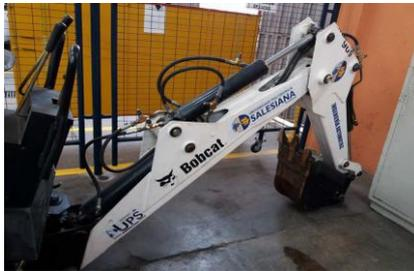
Figura 14. Aditamento Retroexcavadora para Bobcat S175. Fuente: Autores.
