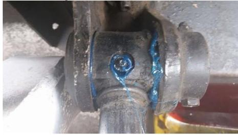
Figura 12. Punto de engrase lubricado correctamente. Fuente: Autores.
