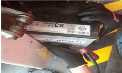
Figura 32. Montaje de la batería en la máquina. Fuente: Autores.
