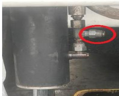
Figura 24. Tapón de acople hidráulico en el cilindro de inclinación. Fuente: Autores.
