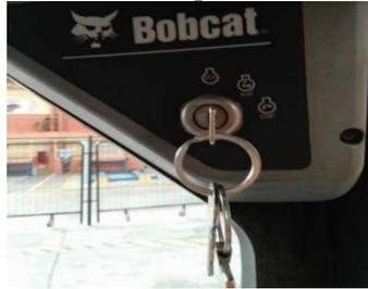
Figura 9. Switch (Apagar el motor). Fuente: Autores.
