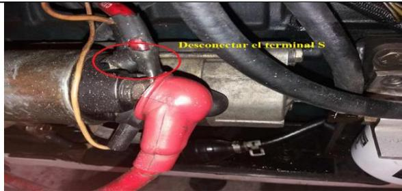
Figura 42. Terminal S del arranque. Fuente: Autores.
