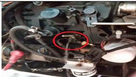
Figura 20. Válvula de drenado de refrigerante abierta. Fuente: Autores.
