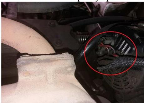
Figura 34. Conectores del alternador. Fuente: Autores.
