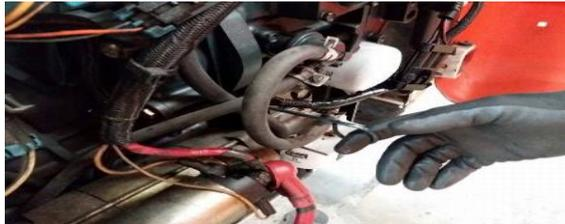
Figura 24. Varilla de nivel de aceite de motor. Fuente: Autores.
