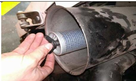
Figura 15. Ajuste de la mariposa del filtro interior. Fuente: Autores.
