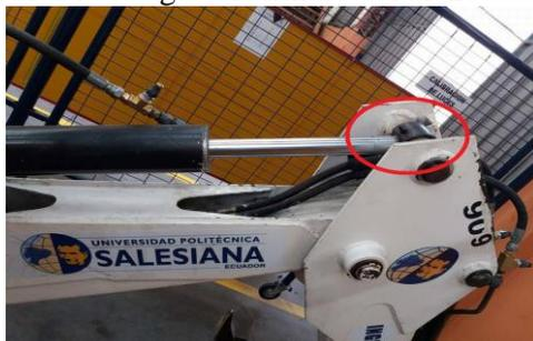
*Figura 30. Punto de lubricación en el extremo del vástago del cilindro del brazo.
