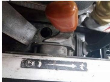
Figura 19. Palanca del acelerador accionada. Fuente: Autores.
