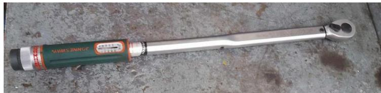
*Figura 2. Torquímetro. Fuente: Autores.*
