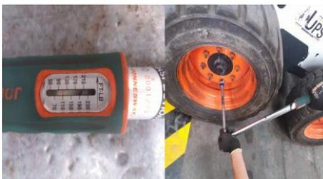
Figura 16. Ajuste de las ruedas con el torquímetro. Fuente: Autores.
