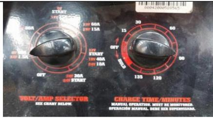
Figura 31. Modo de carga lenta de baterías. Fuente: Autores.
