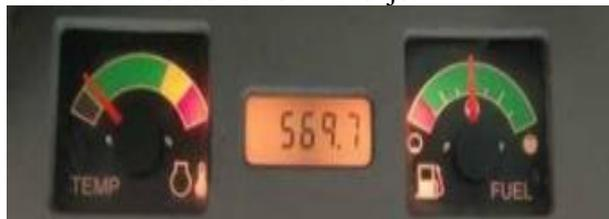
Figura 16. Horómetro digital. Fuente: Autores.
