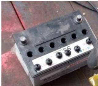
*Figura 19. Tapones de la batería extraídos. Fuente: Autores.*
