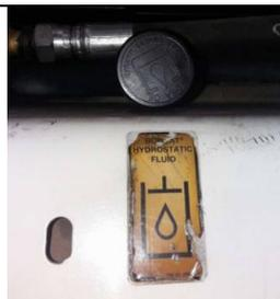
Figura 33. Tapón de llenado de aceite hidrostático ajustado. Fuente: Autores.
