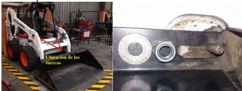
Figura 19. Extracción de las tuercas y arandelas de la cabina. Fuente: Autores.
