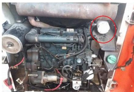
Figura 16. Filtro de aceite hidráulico del cargador Bobcat. Fuente: Autores.
