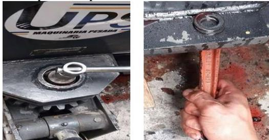
Figura 10. Forma correcta de ajustar el perno del eje. Fuente: Autores.
