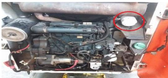
Figura 34. Filtro de aceite hidráulico. Fuente: Autores.
