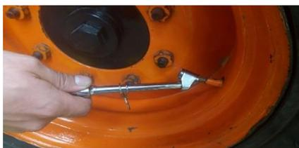
Figura 17. Medición de presión del neumático. Fuente: Autores.
