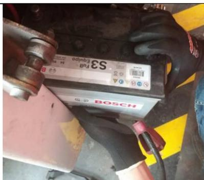
Figura 24. Montaje de la batería en la máquina. Fuente: Autores.
