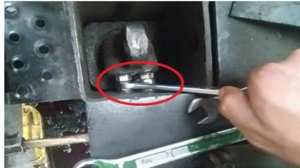
Figura 17. Retirar las cañerías del cilindro hidráulico. Fuente: Autores.
