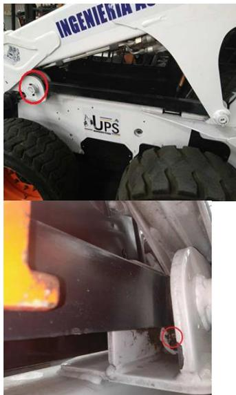
Figura 13. Punto de lubricación en la articulación delantera de la barra estabilizadora. Fuente: Autores.
