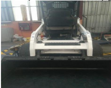
Figura 8. Cabina levantada. Fuente: Autores.
