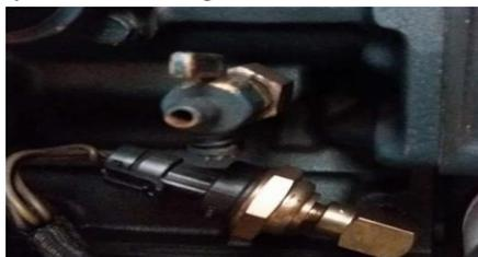
Figura 21. Válvula de drenado de refrigerante cerrada. Fuente: Autores.
