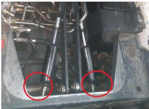
Figura 9. Puntos de engrase de los mandos de desplazamiento. Fuente: Autores.
