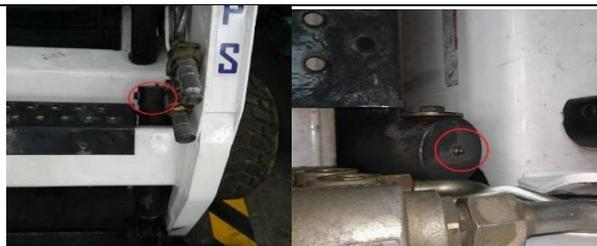
Figura 17. Punto de lubricación en el extremo superior del cilindro de inclinación. Fuente: Autores.
