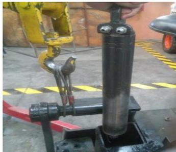
Figura 19. Cilindro hidráulico del estabilizador. Fuente: Autores.
