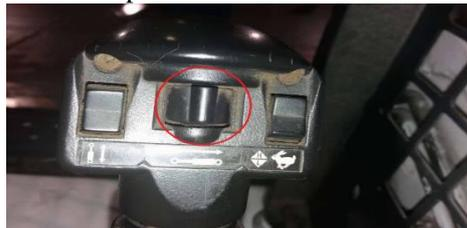
Figura 18. Llave de liberación de la presión del sistema. Fuente: Autores.
