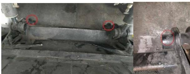
Figura 19. Punto de lubricación en el pivote del Bob-tach. Fuente: Autores.
