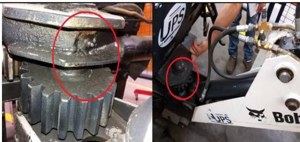
Figura 34. Punto de lubricación en el cojinete del pivote del bastidor oscilante. Fuente: Autores.
