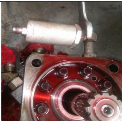
*Figura 11. Ajustar el filtro en el motor hidráulico. Fuente: Autores.*
