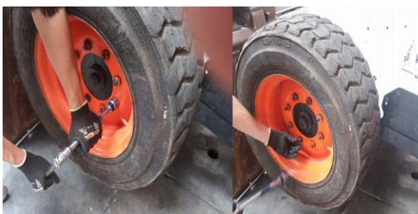
Figura 9. Extracción de las tuercas de la rueda. Fuente: Autores.
