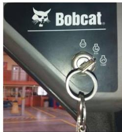
Figura 18. Llave en el switch lista para proceder a dar arranque. Fuente: Autores.
