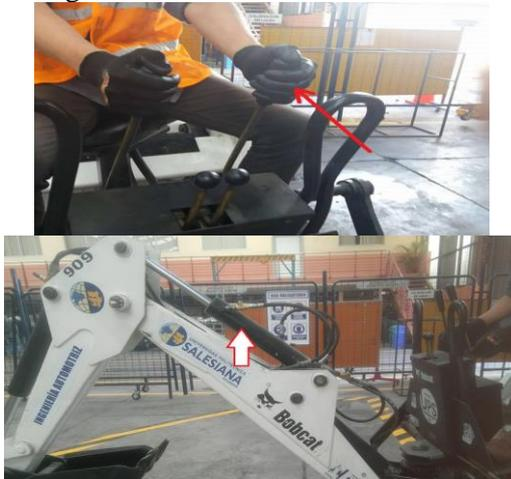
Figura 24. Accionamiento del mando izquierdo hacia atrás. Fuente: Autores.
