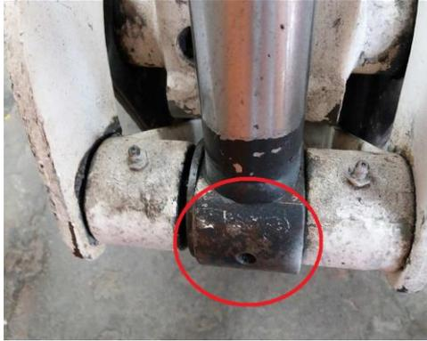
Figura 27. Punto de lubricación en el extremo del vástago del cilindro del cucharón.
