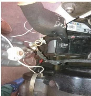
Figura 36. Comprobación con la luz de prueba. Fuente: Autores.
