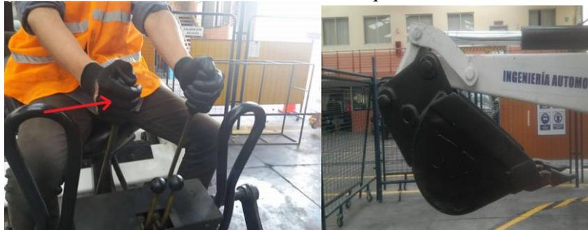
Figura 29. Accionamiento del mando derecho hacia la izquierda. Fuente: Autores.
