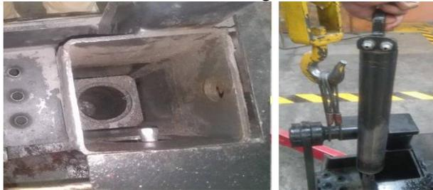
Figura 21. Colocación del cilindro hidráulico en el estabilizador. Fuente: Autores.
