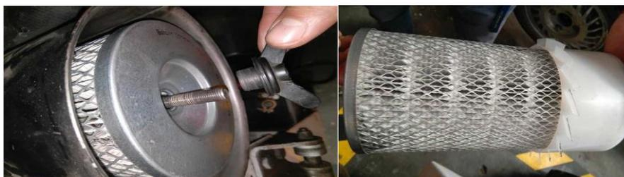
Figura 13. Extracción del filtro de aire exterior. Fuente: Autores.
