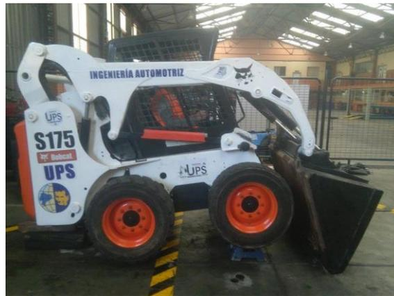
Figura 5. Cargador Bobcat S175 siendo embancado. Fuente: Autores.
