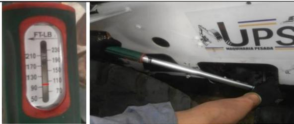
Figura 22. Apriete de los pernos del motor con el torquímetro. Fuente: Autores.
