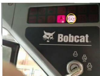
Figura 10. Indicador de baja presión del sistema hidráulico. Fuente: Autores.
