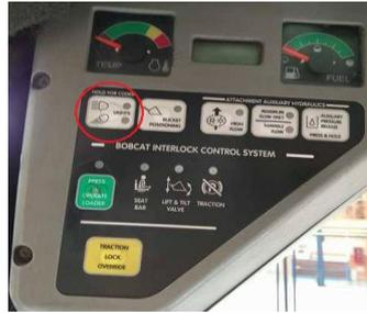
Figura 9. Icono de luces en el panel de controles. Fuente: Autores.
