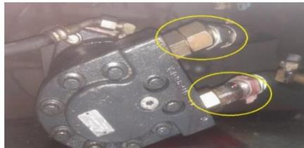
Figura 23. Ajuste de las mangueras al motor. Fuente: Autores.
