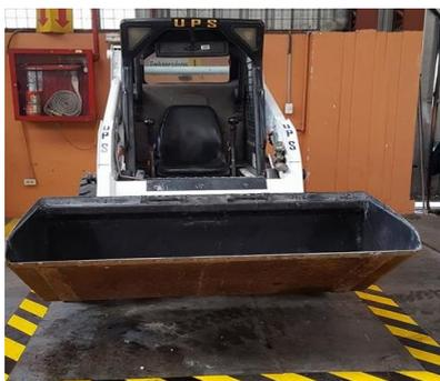
Figura 23. Inclinación del cucharón para llenar. Fuente: Autores.
