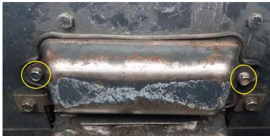
Figura 29. Extracción de la tapa de fusibles. Fuente: Autores.
