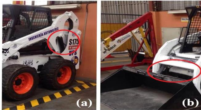
Figura 20. a) Ubicación de los cilindros de elevación. b) Ubicación de los cilindros de inclinación el cargador Bobcat S175. Fuente: Autores.
