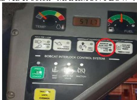
Figura 15. Botón "MAXIMUM FLOW ONLY/VARIABLE FLOW" Fuente: Autores.
