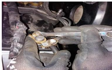
Figura 35. Conexión del borne negativo. Fuente: Autores.
