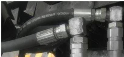
*Figura 2. Mangueras de alta presión del sistema hidráulico del Bobcat S175. Fuente: Autores.*
