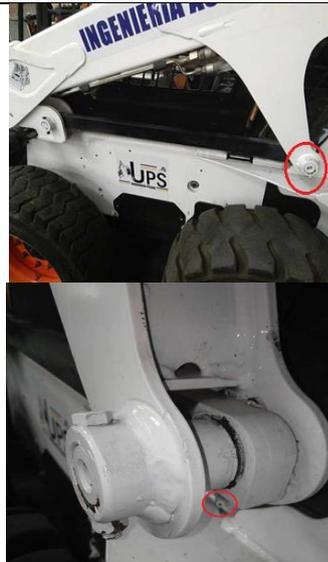
Figura 14. Punto de lubricación en la articulación trasera de la barra estabilizadora. Fuente: Autores.
