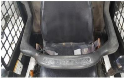
Figura 8. Barra de seguridad del asiento. Fuente: Autores.
