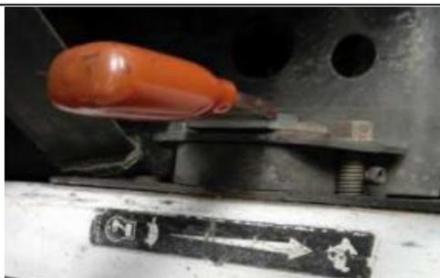
Figura 13. Palanca de aceleración del cargador Bobcat S175. Fuente: Autores.
