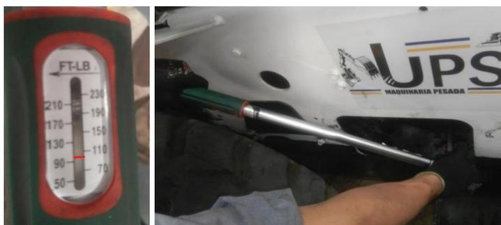
*Figura 13. Apriete de los pernos del motor con el torquímetro. Fuente: Autores.*
