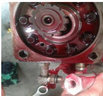
Figura 10. Extraer el filtro del motor hidráulico. Fuente: Autores.
