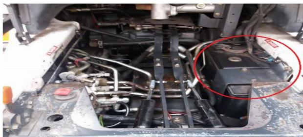
*Figura 12. Depósito hidráulico. Fuente: Autores.*
