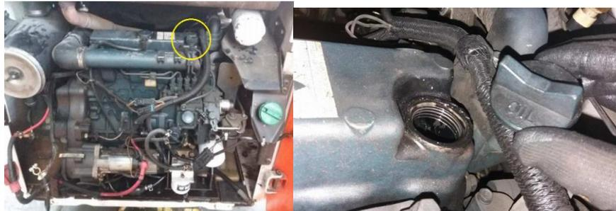
Figura 29. Tapón de llenado de aceite de motor. Fuente: Autores.
