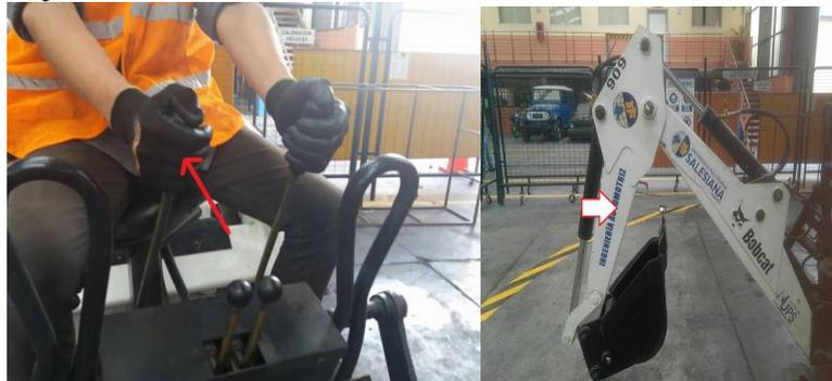
Figura 28. Accionamiento del mando derecho hacia atrás. Fuente: Autores.
