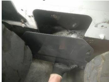
Figura 5. Extracción de la tapa del motor hidráulico. Fuente: Autores.
