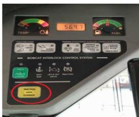
Figura 25. Pulsante “TRACTION LOCK OVERRIDE”. Fuente: Autores.
