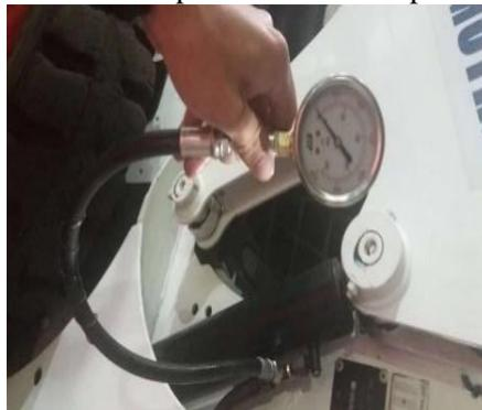
*Figura 22. Medidor de presión instalado. Fuente: Autores.*
