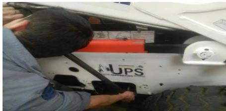
Figura 19. Extracción de los pernos de sujeción del motor hidráulico. Fuente: Autores.
