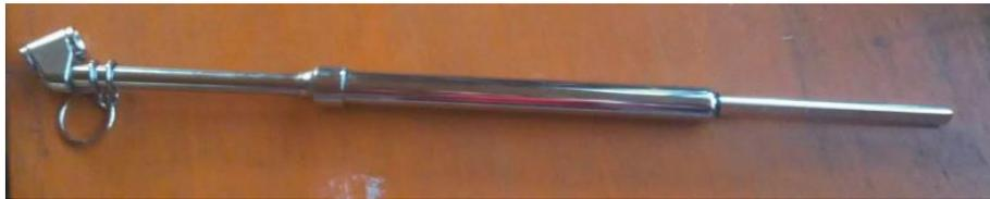
*Figura 1. Medidor de presión de los neumáticos. Fuente: Autores.*
