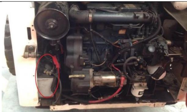
Figura 3. Ubicación de la batería en el cargador Bobcat S175. Fuente: Autores.
