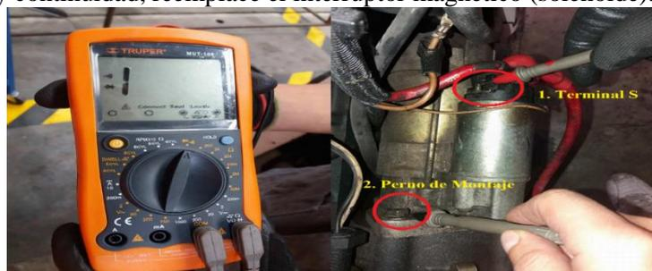
Figura 43. Medición de continuidad entre el terminal S y el perno de montaje. Fuente: Autores.
