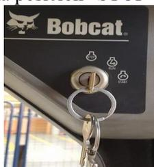
Figura 26. Llave en la posición STOP. Fuente: Autores.
