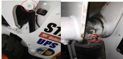
Figura 15. Punto de lubricación en el extremo superior del cilindro de elevación. Fuente: Autores.
