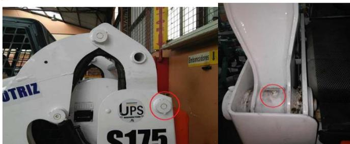
Figura 23. Punto de lubricación en la articulación del brazo de elevación. Fuente: Autores.
