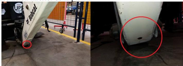
Figura 35. Punto de lubricación en el extremo inferior de la pluma. Fuente: Autores.
