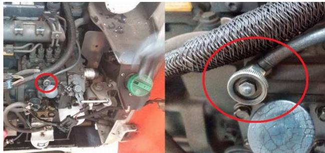
Figura 51. Apertura del respiradero de la bomba de inyección de combustible. Fuente: Autores.
