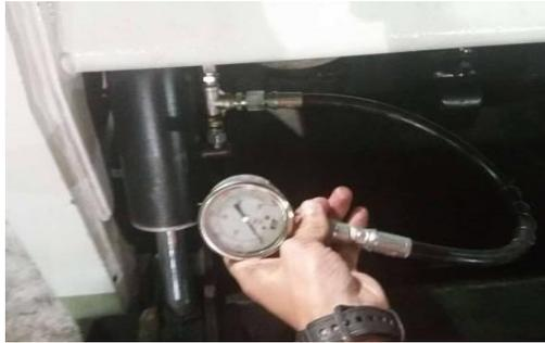
Figura 25. Medidor de presión conectado. Fuente: Autores.
