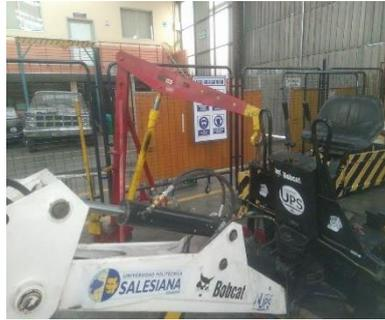
Figura 20. Levantamiento del estabilizador con la pluma hidráulica. Fuente: Autores.
