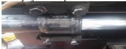
Figura 12. Pernos y bancadas de sujeción del cilindro con cremallera. Fuente: Autores.
