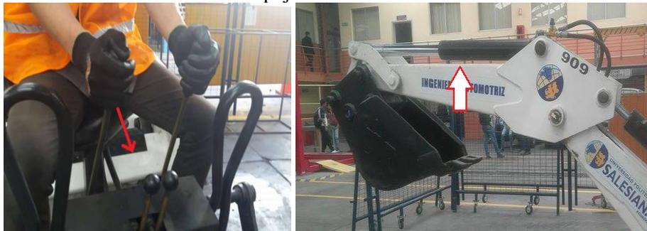
Figura 25. Accionamiento del mando derecho hacia adelante. Fuente: Autores.
