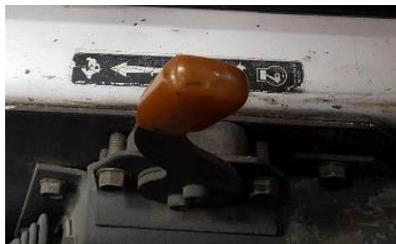
Figura 9. Palanca de acelerador. Fuente: Autores.
