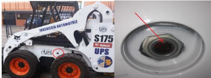
Figura 30. Visor de nivel de aceite hidrostático. Fuente: Autores.
