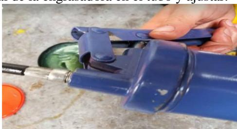
Figura 8. Ajuste del cabezal de la engrasadora. Fuente: Autores.
