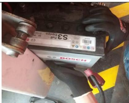
*Figura 17. Extracción de la batería. Fuente: Autores.*
