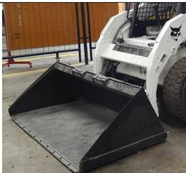
Figura 11. Pala del cargador. Fuente: Autores.
