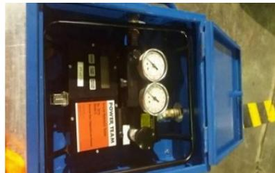
Figura 1. Tester Hidráulico Power Team. Fuente: Autores.
