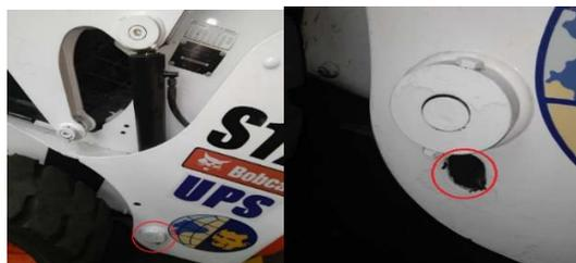
Figura 16. Punto de lubricación en el extremo inferior del cilindro de elevación. Fuente: Autores.
