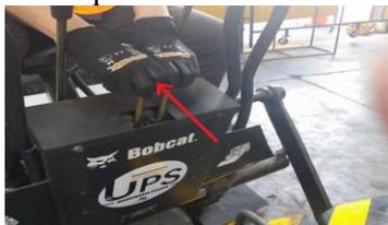
Figura 31. Accionamiento hacia atrás de los mandos centrales. Fuente: Autores.
