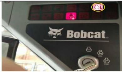
Figura 5. Ícono de temperatura de refrigerante del motor. Fuente: Autores.
