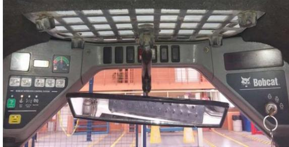
Figura 17. Panel de control y luces indicadoras sin advertencias de fallo. Fuente: Autores.
