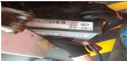
Figura 23. Extracción de la batería. Fuente: Autores.
