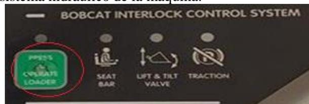
Figura 20. Botón de activación del sistema hidráulico. Fuente: Autores.
