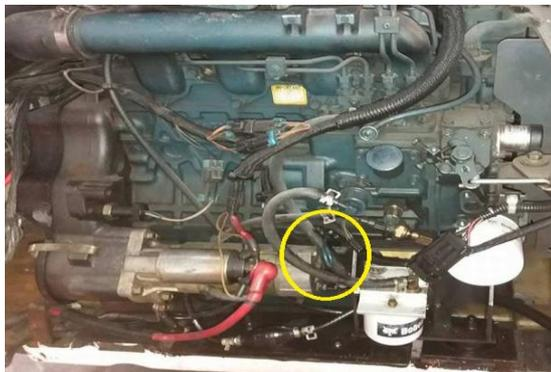
Figura 26. Varilla de nivel de aceite del motor correctamente colocada. Fuente: Autores.
