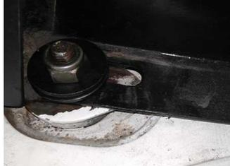
Figura 24. Ajuste de las tuercas que sujetan la cabina. Fuente: Autores.
