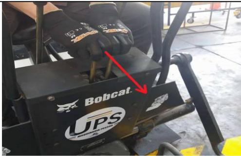
Figura 23. Accionamiento de las palancas que gobiernan los gatos hidráulicos. Fuente: Autores.
