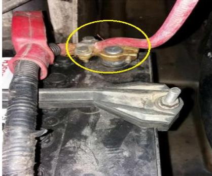
*Figura 15. Borne positivo de la batería. Fuente: Autores.*
