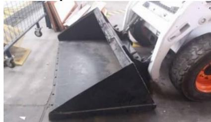
Figura 11. Cucharón de la máquina completamente asentado en el piso. Fuente: Autores.
