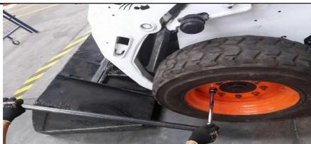
Figura 7. Afloje las tuercas de la rueda del cargador. Fuente: Autores.
