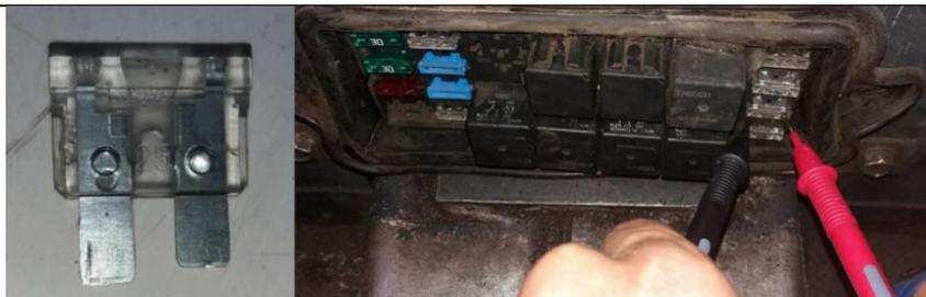
Figura 32. Comprobación del estado de un fusible. Fuente: Autores.
