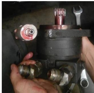
*Figura 23. Motor hidráulico Geroller de un cargador Bobcat S175. Fuente: Autores.*
