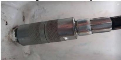
Figura 10. Acople de la engrasadora colocado sobre la graseras de la máquina. Fuente: Autores.
