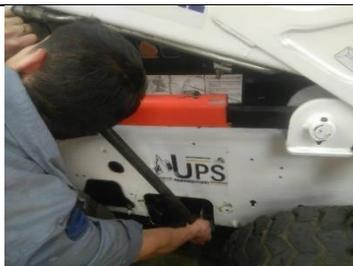
Figura 7. Extracción de los pernos de sujeción del motor hidráulico. Fuente: Autores.
