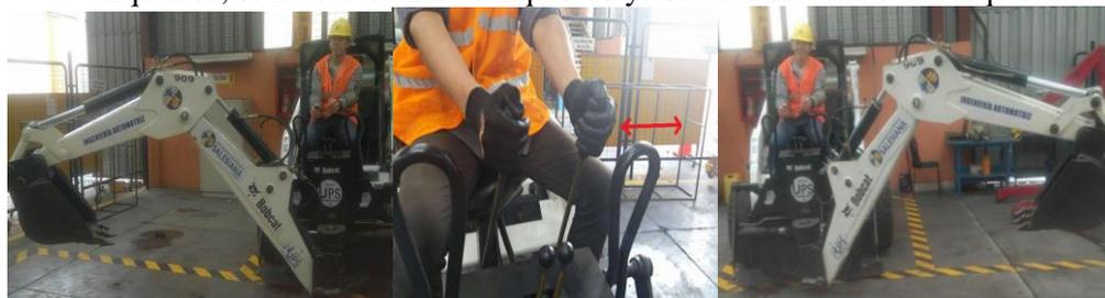
Figura 30. Accionamiento del mando izquierdo hacia la derecha o izquierda. Fuente: Autores.
