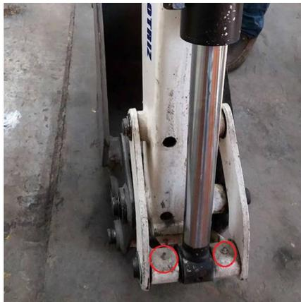
Figura 26. Puntos de lubricación en el enlace superior del cucharón. Fuente: Autores.
