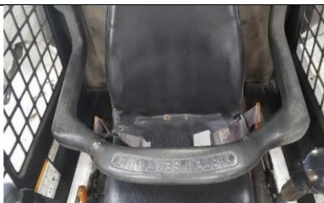
Figura 7. Barra de seguridad del asiento. Fuente: Autores.
