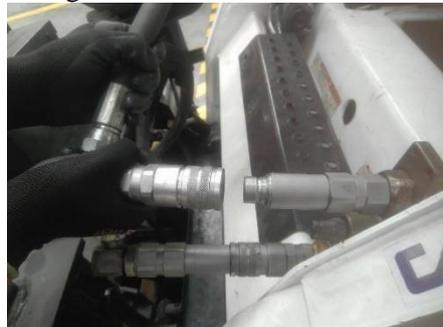
Figura 12. Conexión del puerto hidráulico OUT. Fuente: Autores.
