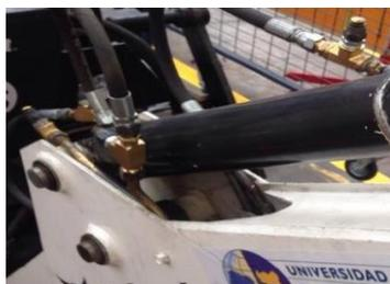
*Figura 13. Mangueras y cañerías hidráulicas en el cargador Bobcat S175. Fuente: Autores.*
