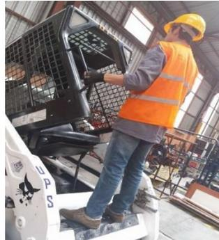
Figura 21. Levantar la cabina hasta que se enclave el mecanismo de seguro. Fuente: Autores.
