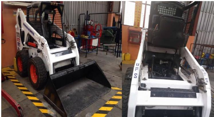
Figura 16. Cargador Bobcat S175, antes y después de levantar la cabina. Fuente: Autores.
