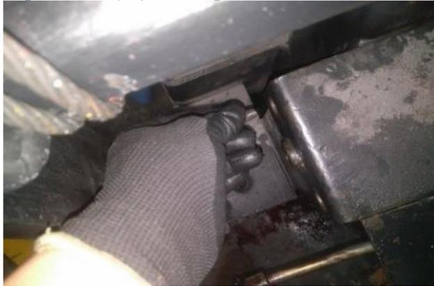
Figura 26. Ajuste de los pernos de la tapa de protección. Fuente: Autores.
