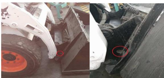
Figura 20. Punto de lubricación en la cuña del Bob-tach. Fuente: Autores.
