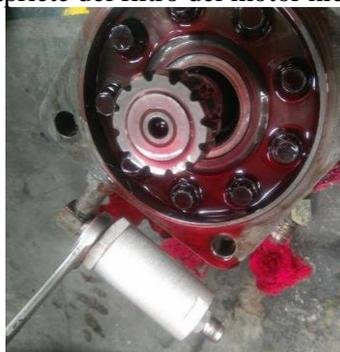
Figura 9. Extraer el filtro del motor hidráulico. Fuente: Autores.
