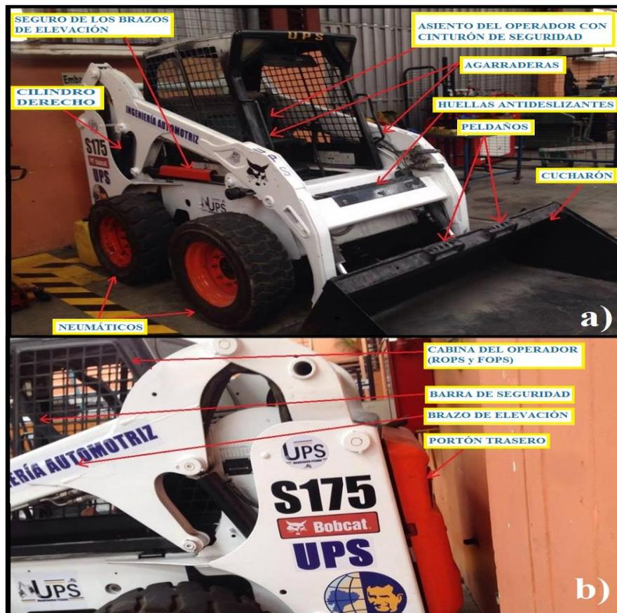
Figura 4. a) Componentes frontales externos de un cargador Bobcat S175. b) Componentes laterales externos de un cargador Bobcat S175. Fuente: Autores.
