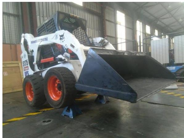
Figura 6. Cargador Bobcat S175 embancado. Fuente: Autores.
