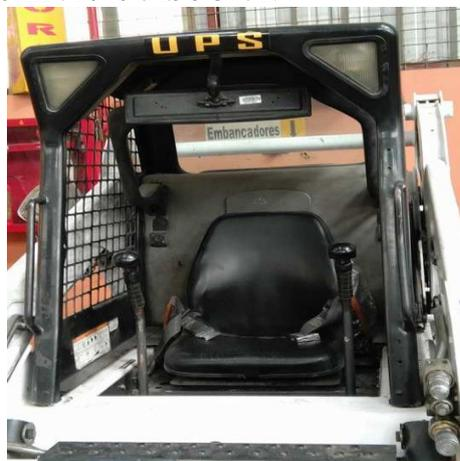
*Figura 5. Cabina del operador. Fuente: Autores.*
