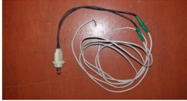
Figura 2. Luz de prueba. Fuente: Autores.
