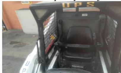
Figura 18. Barra de seguridad en posición de trabajo. Fuente: Autores.
