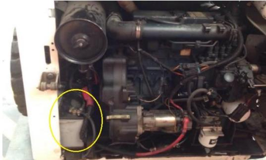
Figura 12. Batería localizada en la parte inferior izquierda del cargador. Fuente: Autores.
