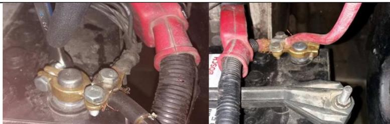
Figura 35. Desconexión de los bornes de la batería. Fuente: Autores.
