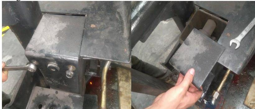
Figura 15. Tapa protectora del cilindro hidráulico del estabilizador. Fuente: Autores.
