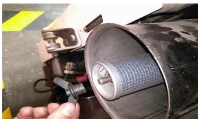
Figura 14. Extracción de la mariposa del filtro interno. Fuente: Autores.
