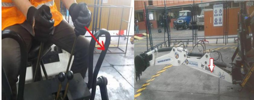
Figura 27. Accionamiento del mando izquierdo hacia adelante. Fuente: Autores.
