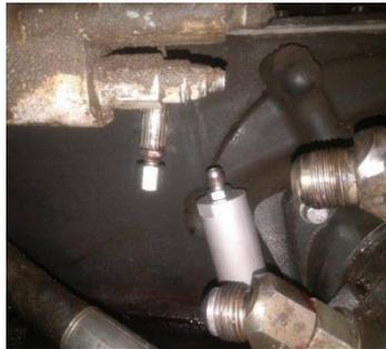
Figura 6. Desconexión de las mangueras del motor hidráulico. Fuente: Autores.
