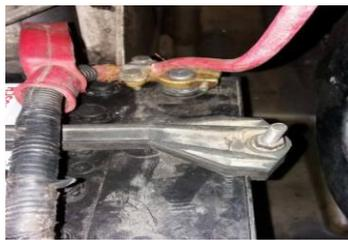
Figura 34. Conexión del borne positivo. Fuente: Autores.
