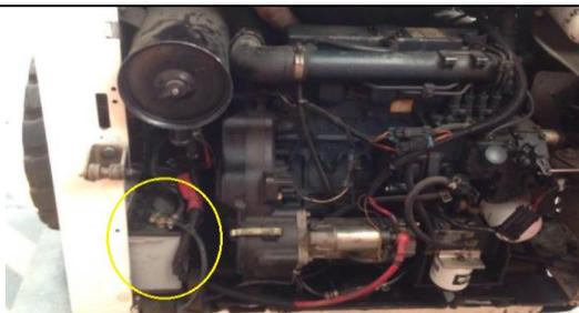
Figura 19. Bateria localizada en la parte inferior izquierda del cargador. Fuente: Autores.
