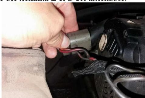
Figura 38. Desconectar el conector L&S del alternador. Fuente: Autores.
