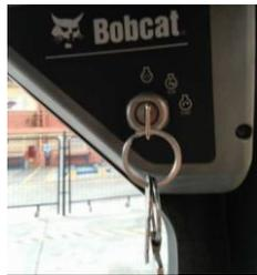
Figura 18. Switch (Apagar el motor). Fuente: Autores.
