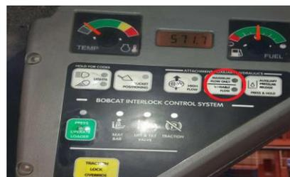
Figura 19. Botón "MAXIMUM FLOW ONLY/VARIABLE FLOW" Fuente: Autores.
