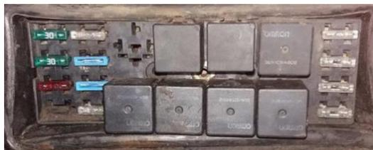
Figura 31. Caja de fusibles y relés. Fuente: Autores.
