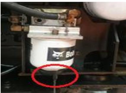
Figura 45. Drenaje de agua del filtro de combustible. Fuente: Autores.
