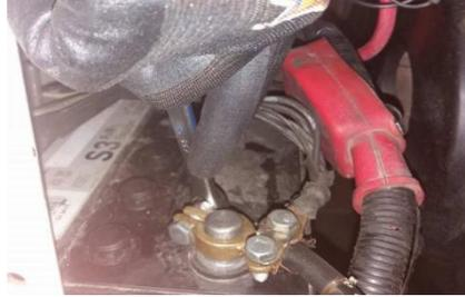
*Figura 14. Desconexión de los bornes de la batería. Fuente: Autores.*
