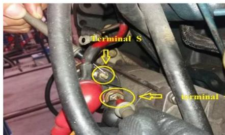
Figura 44. Medición de continuidad entre el terminal positivo y el terminal S del motor de arranque. Fuente: Autores.
