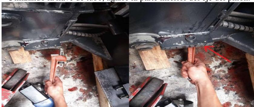
Figura 6. Sujeción del eje desde la parte inferior. Fuente: Autores.
