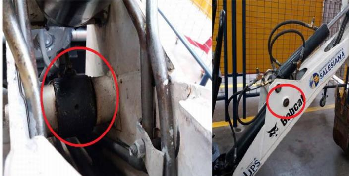
*Figura 32. Punto de lubricación en el extremo de la barra del cilindro de la pluma. Fuente: Autores.*
