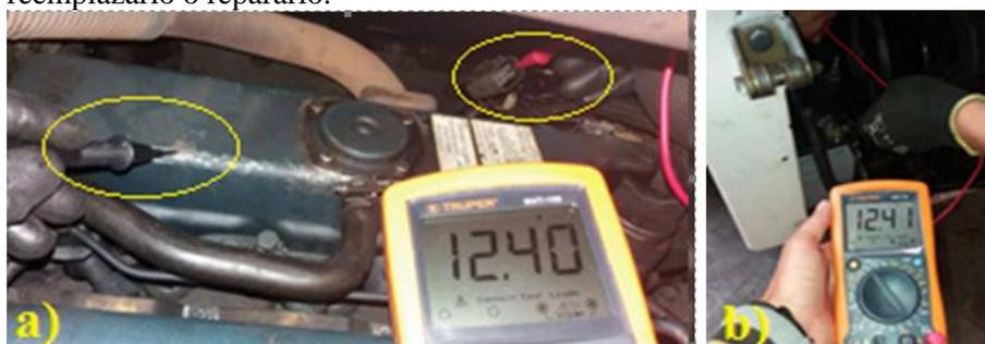
Figura 39. a) y b) Comprobación de voltaje en el terminal L del conector del alternador.
