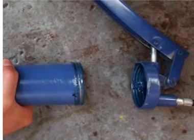
Figura 6. Cabezal de engrasadora extraído. Fuente: Autores.
