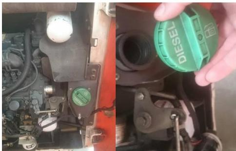
Figura 41. Tapón del depósito de combustible. Fuente: Autores.
