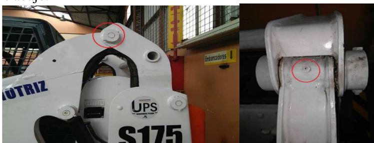
Figura 22. Punto de lubricación en el pivote superior del brazo de elevación. Fuente: Autores.
