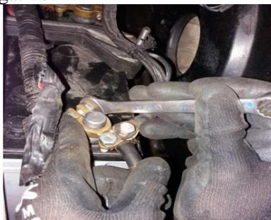
Figura 26. Conexión del borne negativo. Fuente: Autores.
