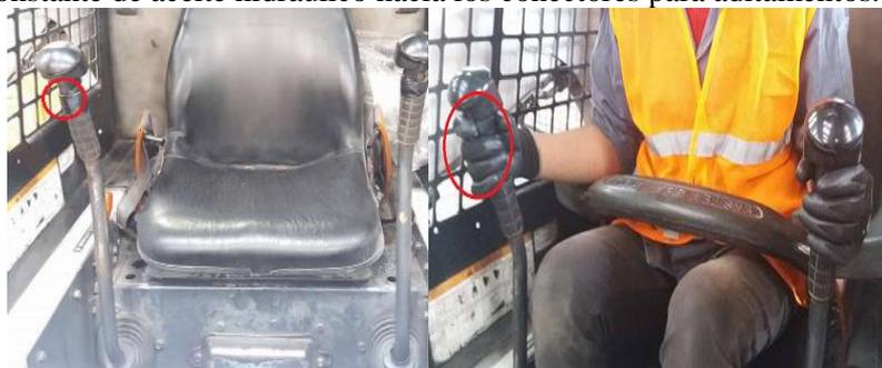
Figura 16. Activación en el pulsante del mando derecho de desplazamiento. Fuente: Autores.
