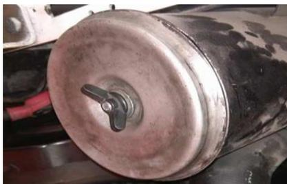
Figura 17. Ajuste de la mariposa de la cubierta antipolvo. Fuente: Autores.
