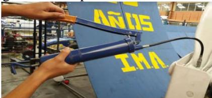
Figura 11. Engrasado de la junta. Fuente: Autores.
