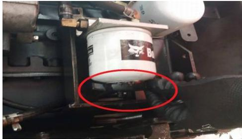
Figura 50. Respiradero del filtro de combustible cerrado. Fuente: Autores.
