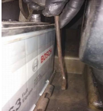
*Figura 16. Varilla de sujeción de la batería desenganchada. Fuente: Autores.*
