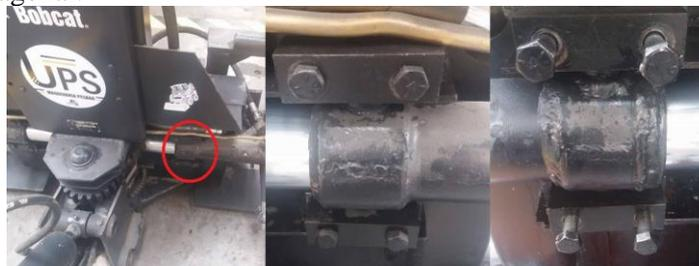
Figura 4. Aflojar los pernos de las bancadas sujetadoras del cilindro hidráulico con cremallera. Fuente: Autores.
