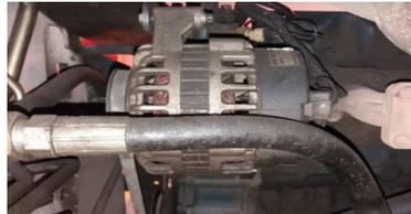
Figura 4. Alternador del cargador Bobcat S175. Fuente: Autores.
