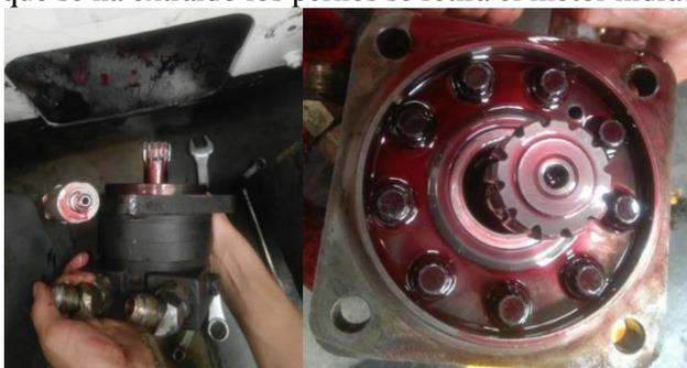
Figura 8. Extracción del motor hidráulico. Fuente: Autores.
