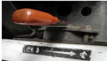
Figura 11. Palanca de aceleración del cargador Bobcat S175. Fuente: Autores.
