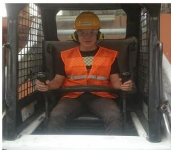
Figura 37. Operador con la barra y cinturón de seguridad. Fuente: Autores.
