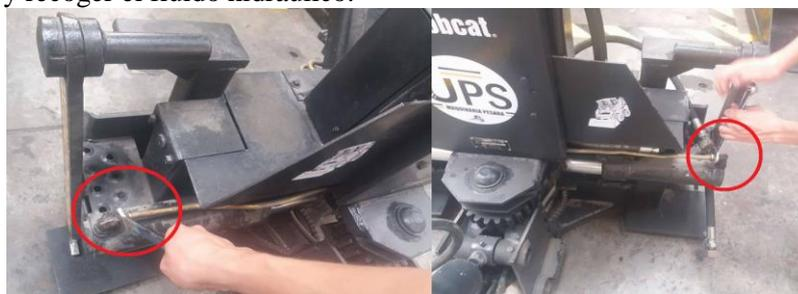
Figura 3. Aflojar las cañerías del cilindro hidráulico oscilante. Fuente: Autores.
