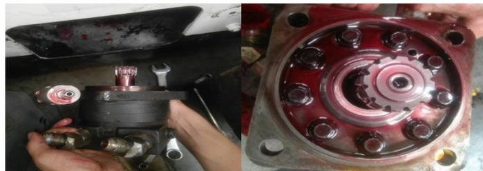
Figura 20. Extracción del motor hidráulico. Fuente: Autores.
