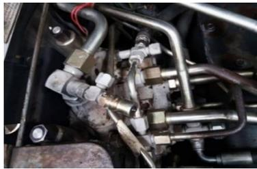
*Figura 24. Cuerpo de válvulas de un cargador Bobcat S175. Fuente: Autores.*
