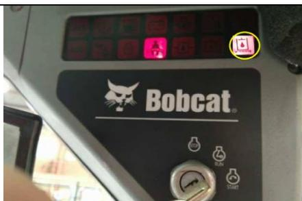
Figura 11. Indicador de falla del filtro de aceite del sistema hidráulico. Fuente: Autores.
