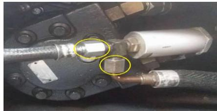
*Figura 16. Desc onexión de las mangueras del filtro del motor hidráulico. Fuente: Autores..*
