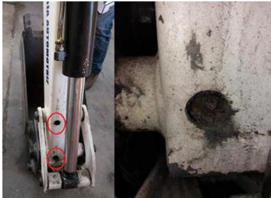
Figura 25. Puntos de lubricación en las articulaciones del cucharón. Fuente: Autores.
