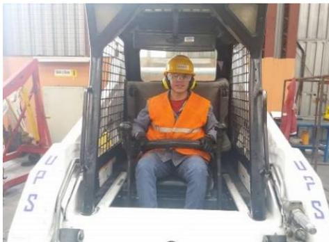
Figura 15. Operador con la barra de seguridad. Fuente: Autores.
