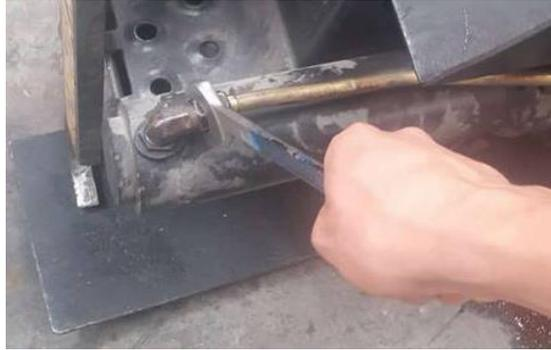
Figura 13. Conexión y ajuste de las cañerías hidráulicas. Fuente: Autores.
