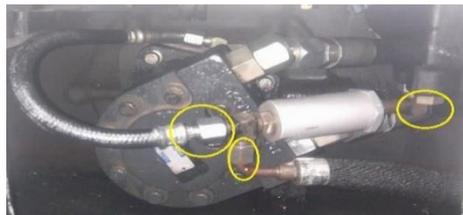
Figura 24. Conexión de las cañerías del filtro del motor hidráulico. Fuente: Autores.
