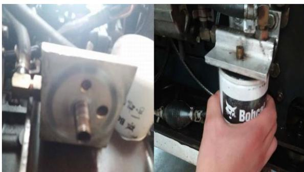
Figura 47. Instalación de un nuevo filtro de combustible. Fuente: Autores.
