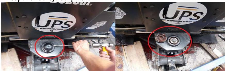
Figura 5. Tapa superior del eje del piñón. Fuente: Autores.
