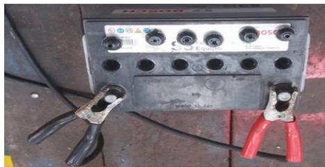
*Figura 29. Pinzas del cargador conectadas a la batería del cargador. Fuente: Autores.*
