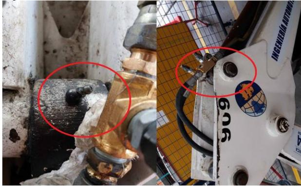
Figura 28. Punto de lubricación en el extremo base del cilindro del cucharón. Fuente: Autores.
