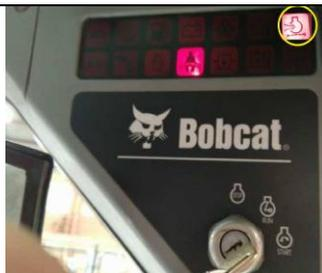
Figura 8. Indicador de falla del filtro de aire del motor. Fuente: Autores.
