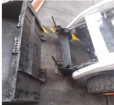
Figura 13. Pala o cucharón del cargador retirado. Fuente: Autores.
