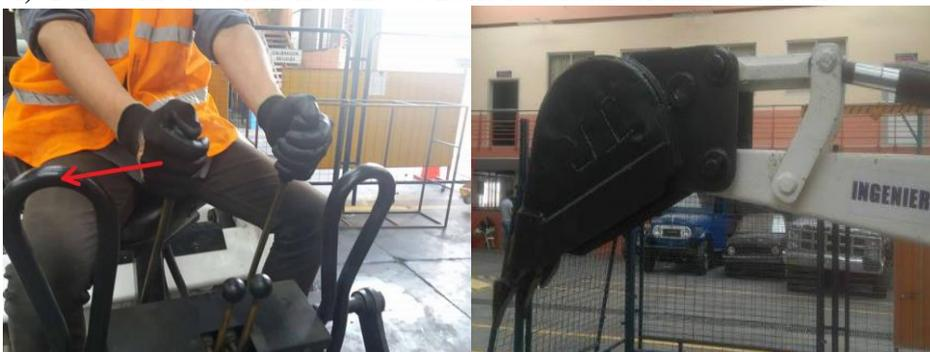
Figura 26. Accionamiento del mando derecho hacia la derecha. Fuente: Autores.
