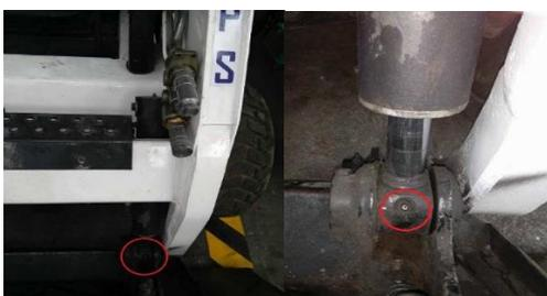
Figura 18. Punto de lubricación en el extremo inferior del cilindro de inclinación. Fuente: Autores.
