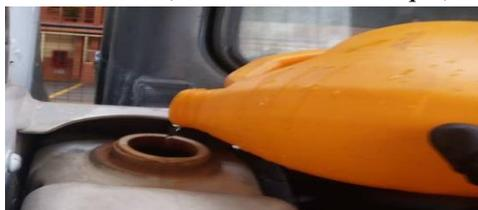
Figura 22.. Añadir refrigerante al depósito. Fuente: Autores.
