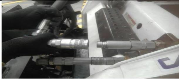
*Figura 20. Puerto hidráulico OUT desconectado. Fuente: Autores.*
