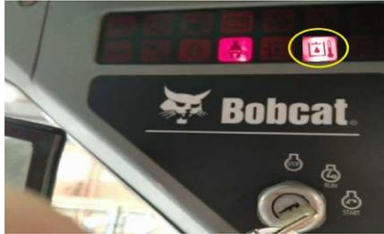
Figura 3. Ícono de la temperatura del aceite hidráulico. Fuente: Autores.
