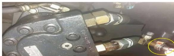
*Figura 17. Filtro del motor hidráulico extraído y cañería de desconexión taponada. Fuente: Autores.*
