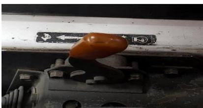
Figura 8. Palanca de acelerador. Fuente: Autores.
