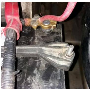
Figura 25. Conexión del borne positivo. Fuente: Autores.
