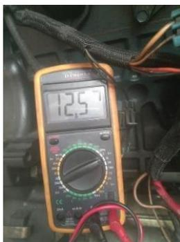
Figura 20. Medición de voltaje de la batería. Fuente: Autores.
