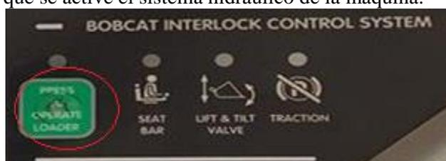
Figura 14. Botón de activación del sistema hidráulico. Fuente: Autores.
