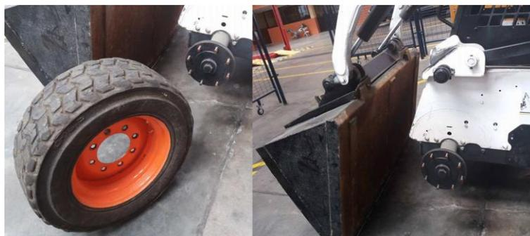
Figura 10. Retire la rueda del cargador. Fuente: Autores.
