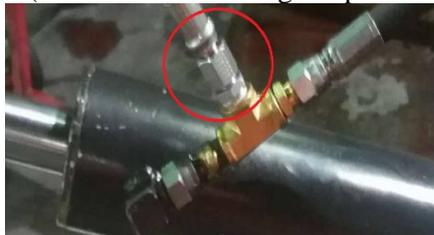
Figura 303. Tapón de un acople hidráulico instalado en un cilindro del aditamento. Fuente: Autores.
