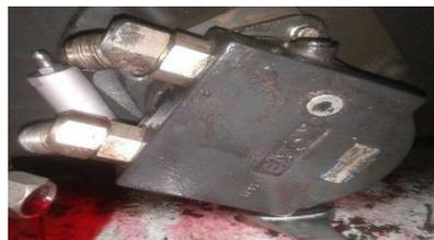
Figura 21. Montaje del motor hidráulico en su lugar de funcionamiento. Fuente: Autores.
