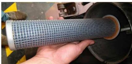
Figura 15. Extracción del filtro interior. Fuente: Autores.
