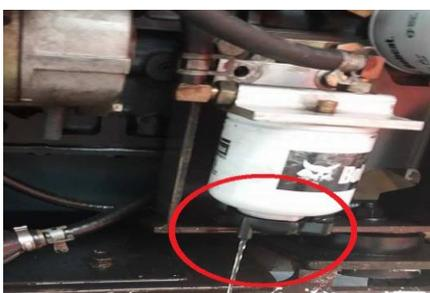
Figura 48. Apertura del respiradero del filtro de combustible. Fuente: Autores.
