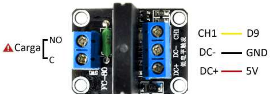
Figura 40: Estructura de relé de estado sólido (LLamas, 2016).
