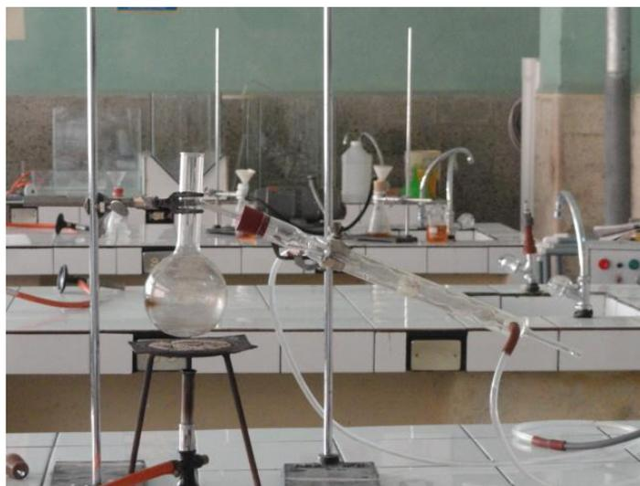
**Ilustración 13.** Equipo utilizado para realizar la destilación de la solución de Almidón de papa (*Solanum Tuberosum L*) y la bacteria, *Lactobacillus Delbrueckii Bulgaricus* (ATCC®7830)
