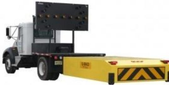
Figura 13. Terminal atenuador de impacto móvil.
