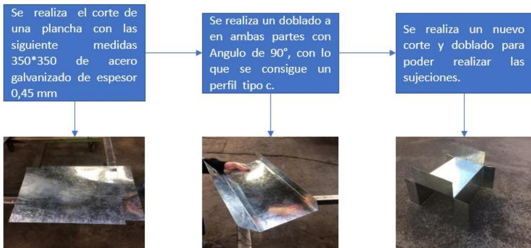
Figura 58. Proceso de doblado del elemento deformable de la estructura del terminal atenuador.
