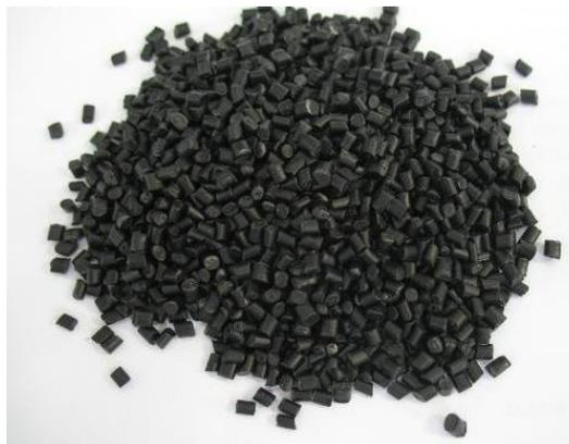
Figura 35. Plástico ABS granulado.
