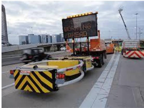
Figura 18. Terminal atenuador de impacto en obra vial.
