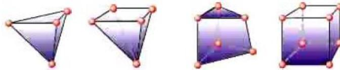
Figura 21. Formas de elementos Tipo SOLID.
