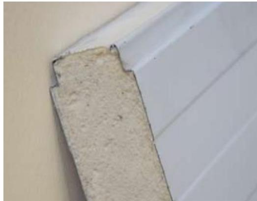
Figura 32. Sandwich de espuma de poliuretano.
