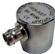
Figura 3. Sensor de EA tipo diferencial de banda ancha.
