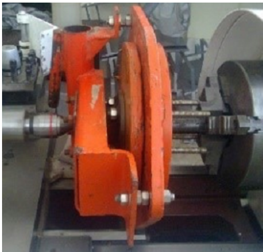
Figura 11. Montaje del generador en el torno.
