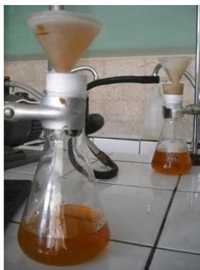
**Ilustración 15.** Filtración de las muestras para eliminar los flóculos
