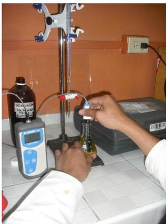
**Ilustración 16.** Ajuste del potencial de hidrógeno mediante goteo
