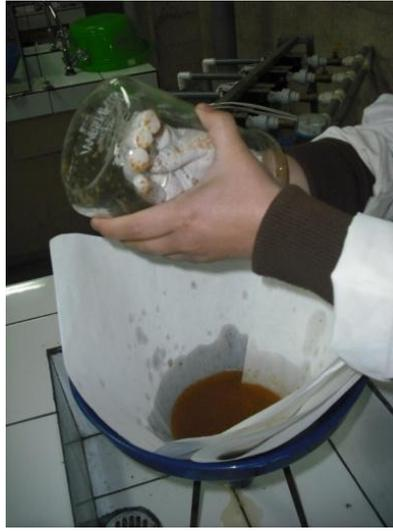
Filtrado del remanente utilizando papel filtro y lavando con agua destilada hasta obtener pH neutro.
