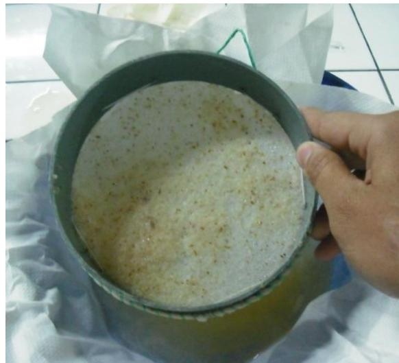
Desacetilación con solución de hidróxido de sodio al 50% en relación 1:4 sólido-líquido, con agitación constante durante 2 horas a 60 °C y luego 2 durante 2 horas a 100 °C. El producto se lava con agua destilada hasta obtener su neutralidad.
