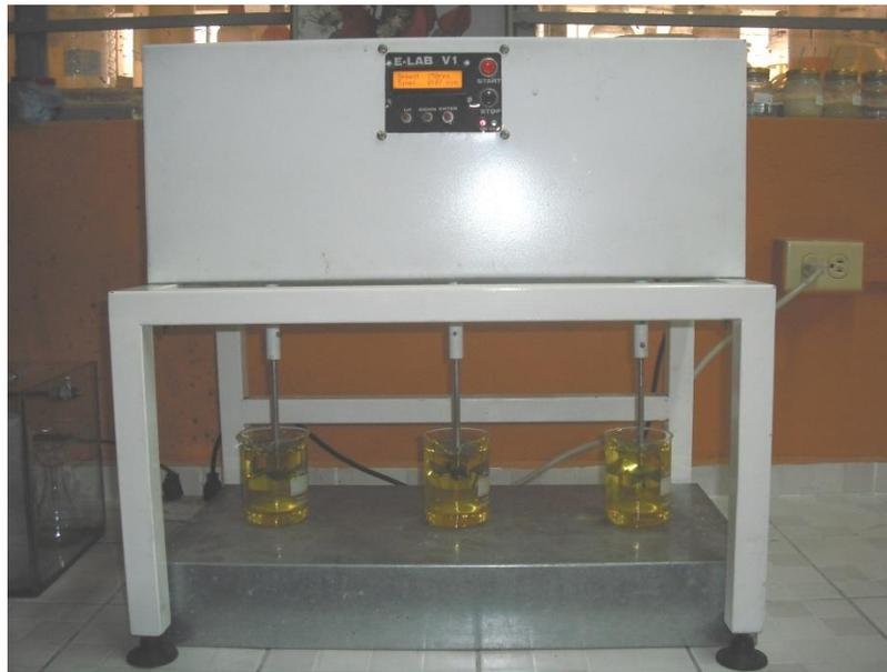
**Ilustración 12.**Equipo floculador utilizado para la prueba de jarras
