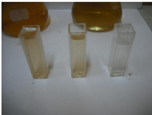
**Ilustración 18.**Celdas para lectura en el espectrofotómetro
