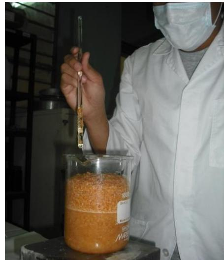
Desmineralización de la cáscara de camarón durante 3 horas, con ácido clorhídrico 0,6 N en relación 1:11 sólido líquido, a 30° de temperatura y agitación constante utilizando un agitador magnético.
