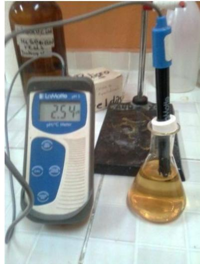
Ajuste del pH mediante goteo de ácido sulfúrico, antes de realizar la titulación.
