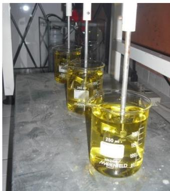
**Ilustración 14.** Prueba de tratabilidad realizada a las muestras de agua
