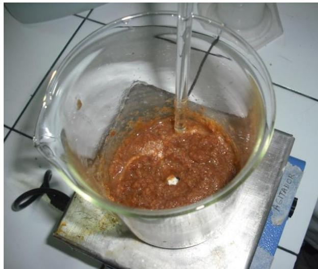
El remanente de la etapa anterior se somete a desproteínización con una solución de hidróxido de sodio al 1%, en relación 1:6 sólido-líquido, a 28 °C y agitación constante durante 24 horas.
