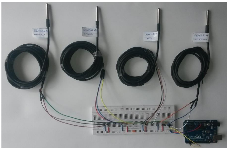
Figura 19. Sensores DS18B20 usados en la recolección de datos de temperatura. Fuente: Autores.
