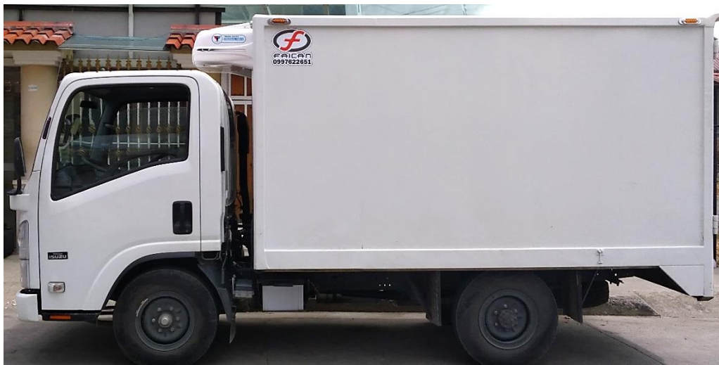
Figura 12. Furgón frigorífico para el estudio. Fuente: Autores.
