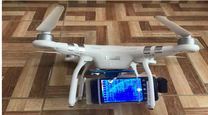
Figura 2.2 Colocación de soporte impreso en 3D para sujeción del sistema de visión térmica Elaborado por: Marco Ramos y Gabriel Molina
