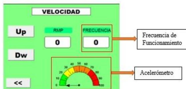
Figura 8. Indicadores de la pantalla de configuración de la velocidad.
