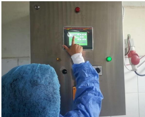
Configuración de los parámetros de funcionamiento a través del panel de operador. (Pérez & Cofre)
