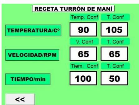
Parámetros de funcionamiento de la máquina en modo automático. (Pérez & Cofre)
