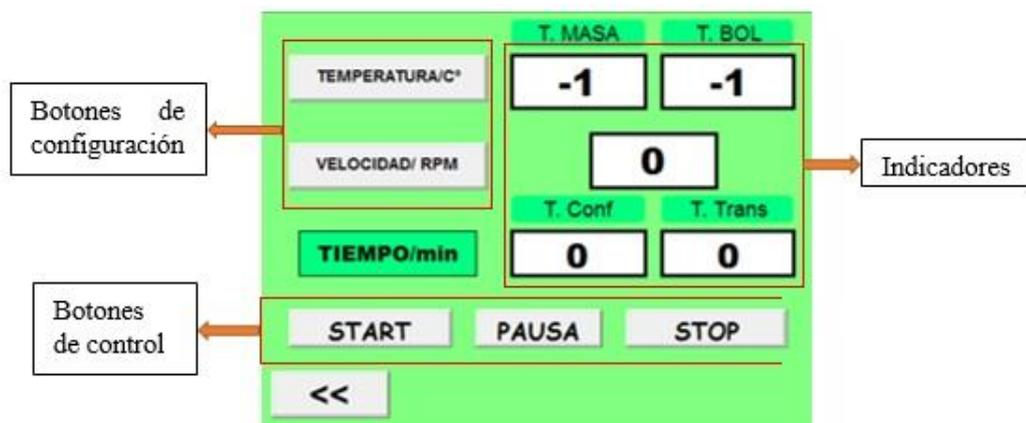
Figura 3. Elementos de la pantalla de control.
