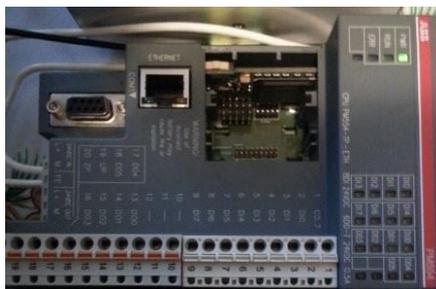
PLC PM554-ETH utilizado para el control de la máquina batidora de turrón. (Pérez & Cofre)
