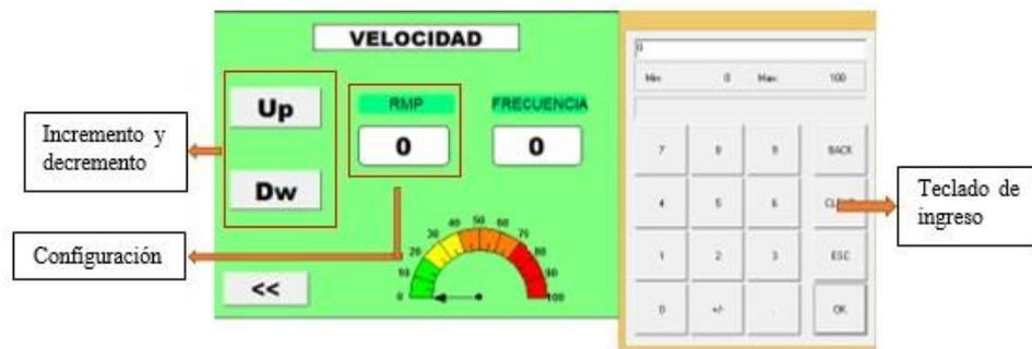
Figura 7. Controles de la pantalla de configuración de la velocidad.
