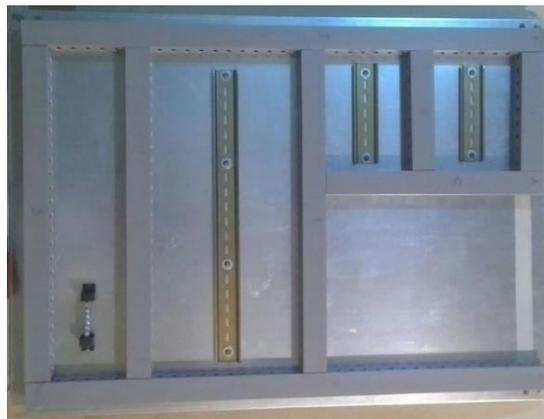
Preparación e instalación del doble fondo o plafón del tablero de control para la batidora de turrón. (Pérez & Cofre)
