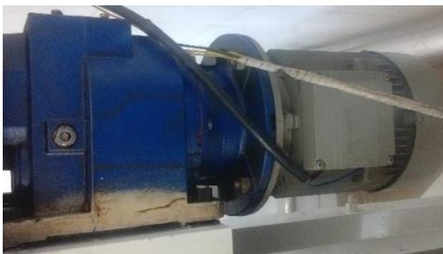
Motor AC trifásico SIEMENS con caja reductora utilizado para la batidora de turrón. (Pérez & Cofre)
