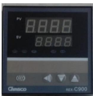
Pirómetro CAMSCO de la serie REX-C900 utilizado para controlar la temperatura de la batidora de turrón. (Pérez & Cofre)
