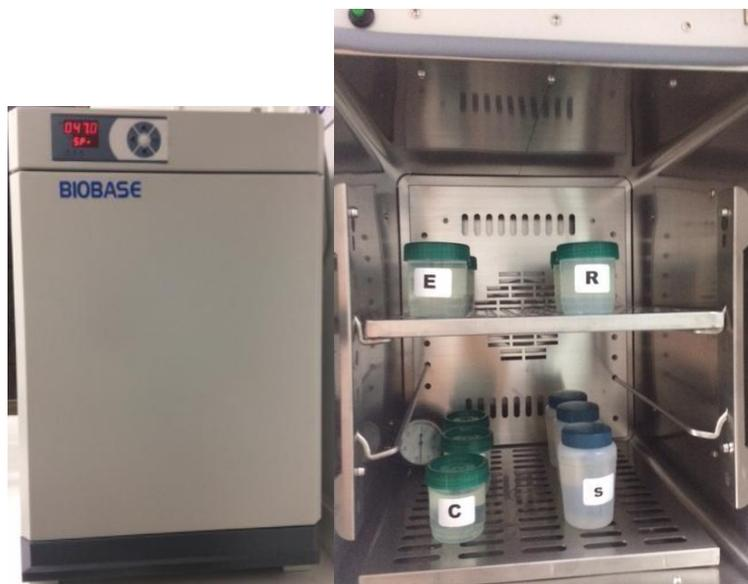
Muestras en la incubadora por ciclos de 24 horas a  $45 \pm 2 \text{ }^\circ\text{C}$
