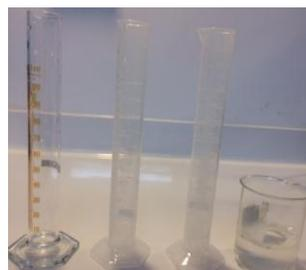
2. Transferir a una probeta 20 mL.
