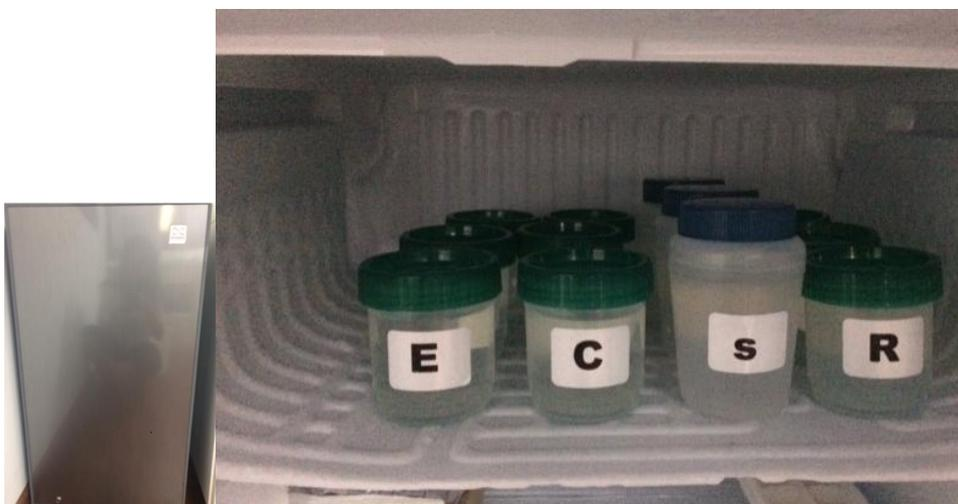
Muestras en la refrigeradora por ciclos de 24 horas a  $-5 \pm 2 \text{ }^\circ\text{C}$
