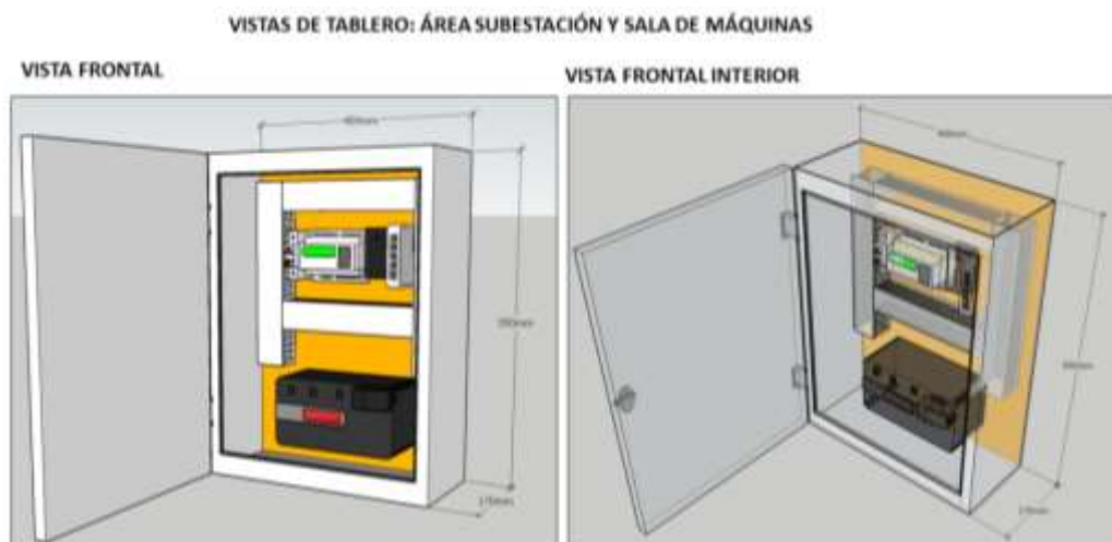
Figura 0.5 Diseño de Tablero para Área de Subest. Eléctrica y Sala de Máquinas
