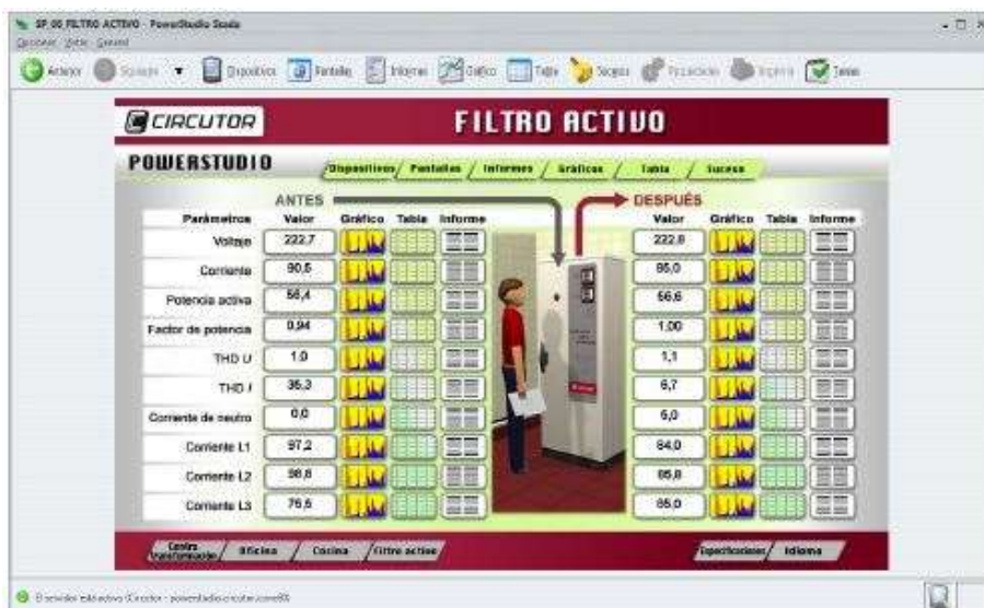
Figura 0.42. Pantalla de cliente. Visualización de pantalla SCADA. (CIRCUTOR S.A., 2015)
