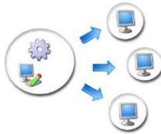
Figura 0.36. Topología Editor-Motor y Clientes. Editor y el motor se encuentran en la misma PC, y el cliente está en una o muchas PC's (CIRCUTOR S.A., 2013)
