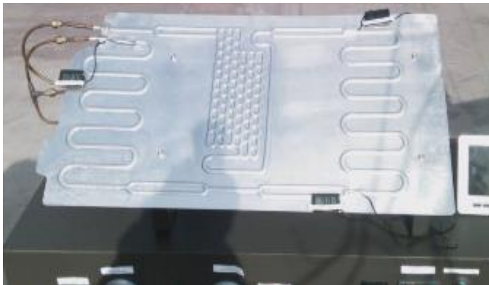
Figura A 6.2. Imagen de luz visible del colector-evaporador.
