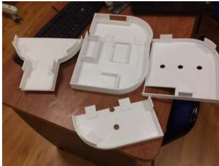
Figura 7. Partes del dispositivo impresos en 3D
