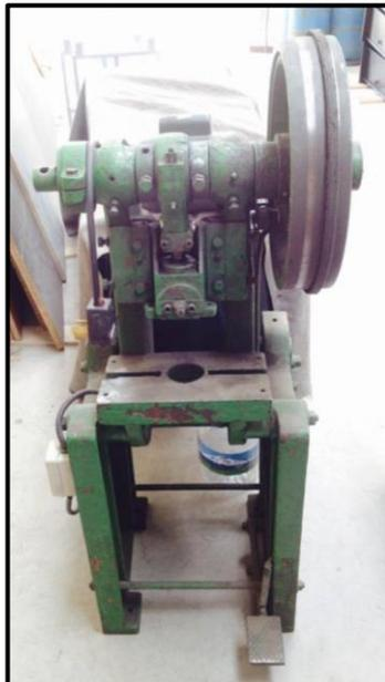
Figura 1. Prensa mecánica
