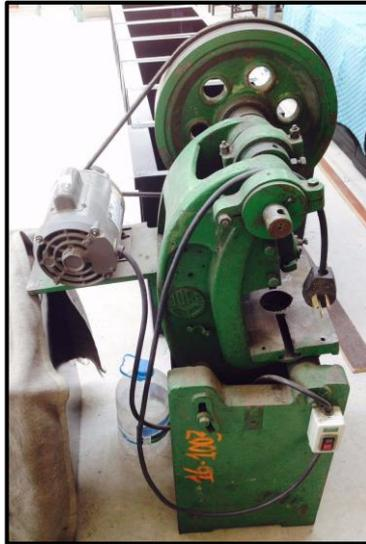
Figura 23. Prensa mecánica
